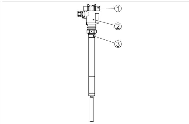
Figura 1: VEGAVIB 63 con custodia di resina
