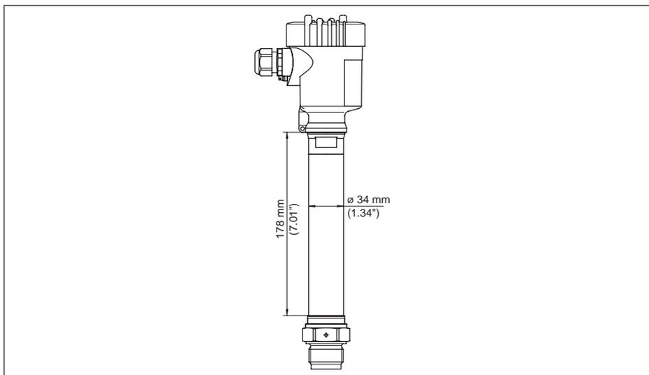
Figura 33: Pezzo intermedio di isolamento termico
