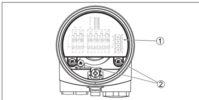
Figura 27: Svitare le viti di fissaggio
