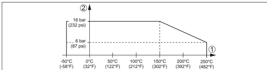
Figura 28: Pressione di processo - Temperatura di processo
