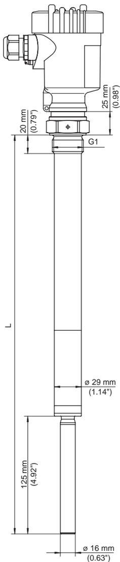
Figura 31: VEGAVIB 63 - Esecuzione filettata G1 (DIN ISO 228/1)
