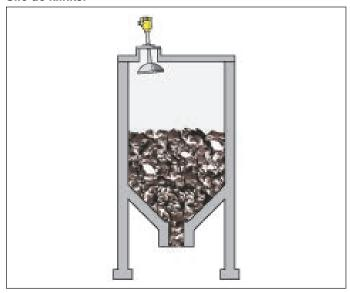
Fig. 18: Mesure de niveau dans un silo de clinker avec le VEGAPULS 68
