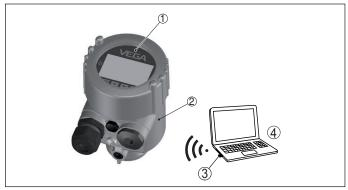
Fig. 32: Raccordement du PC via un adaptateur Bluetooth-USB
