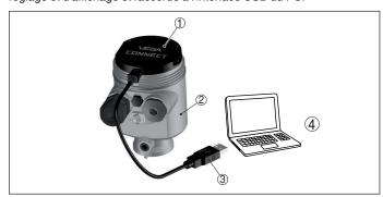
Fig. 30: Raccordement du PC via VEGACONNECT et USB
