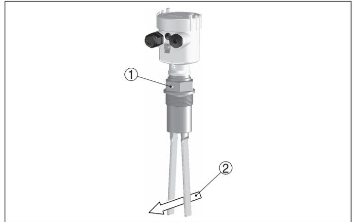
Fig. 20: Orientation des lames dans le sens d'écoulement du produit
