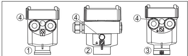
Abb. 10: Werkstoffvarianten Einkammergehäuse
