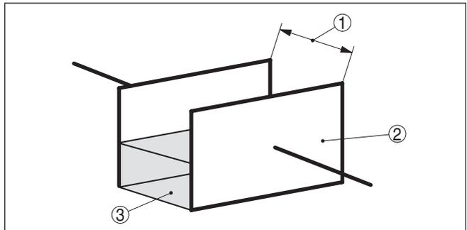
Abb. 3: Funktionsprinzip - Plattenkondensator
