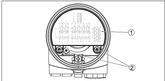
Abb. 15: Halteschrauben lösen
