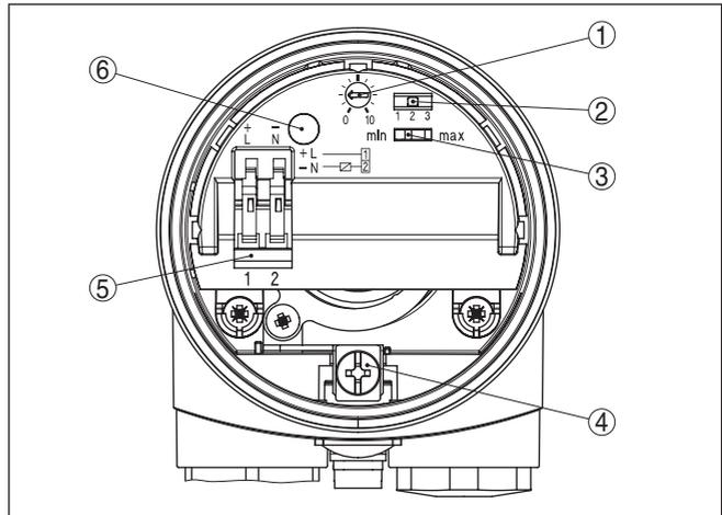
Abb. 13: Elektronikeinsatz - kontaktloser Schalter
