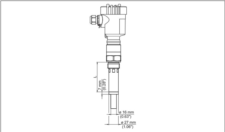
Abb. 22: VEGACAP 62, Abschirmrohr z. B. gegen starke Kondensatbildung
