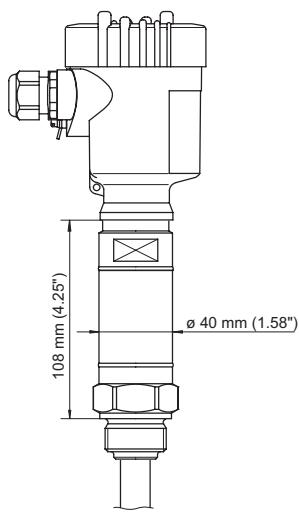
插图. 18: 温度连接元件
