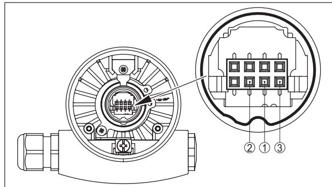
插图. 12: 检查测量探头内的电阻
