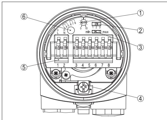
插图. 11: 带继电器输出的电子插件
