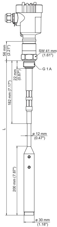
插图. 22: VEGACAP 65 , 绳型 ø 12 mm (0.472 in) , 螺纹型 G1 (ISO 228 T1)
