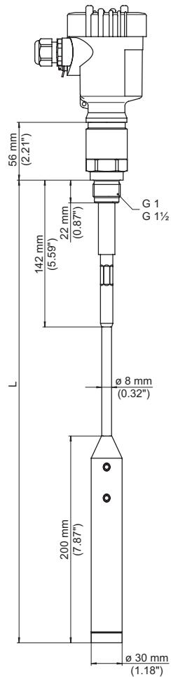
插图. 21: VEGACAP 65 , 绳型 ø 8 mm (0.315 in) , 螺纹型 G1 (ISO 228 T1)
