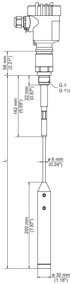
插图. 20: VEGACAP 65 , 绳型  $\varnothing$  6 mm (0.236 in) , 螺纹型 G1 (ISO 228 T1)
