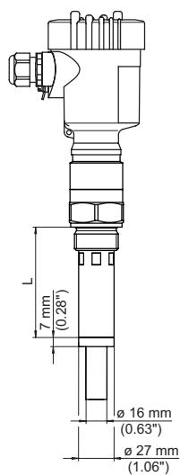
插图. 24: VEGACAP 65, 屏蔽管 , 如用于防止冷凝水大量积聚
