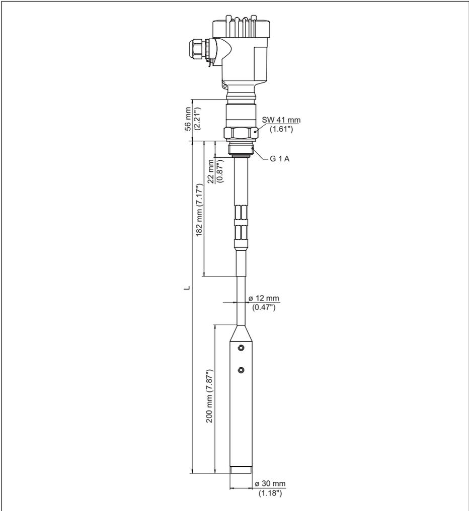
Fig. 22: VEGACAP 65, version câble avec  $\varnothing$  de 12 mm (0.472 in), version fileté G1 (ISO 228 T1)
