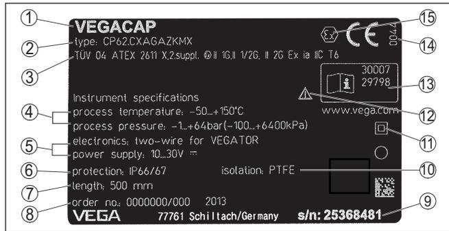
Fig. 2: Présentation de la plaque signalétique (exemple)
