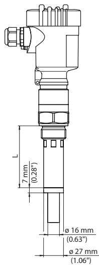
插图. 19: VEGACAP 66, 屏蔽管 , 如用于防止冷凝水大量积聚
