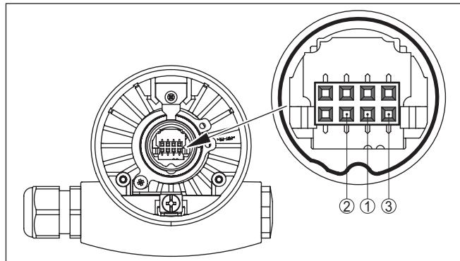
插图. 13: 检查测量探头内的电阻
