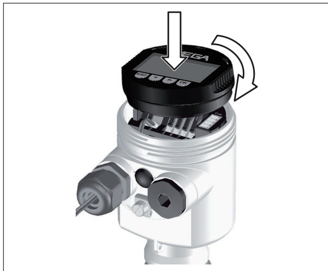
Abb. 21: Anzeige- und Bedienmodul im Einkammergehäuse einsetzen
