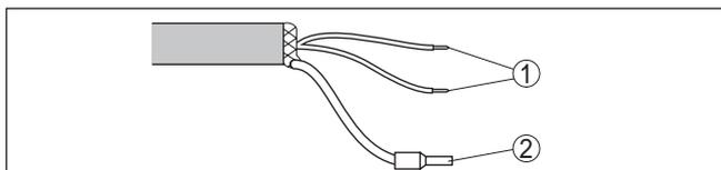
Fig. 20: Ocupación de conductores del cable de conexión
