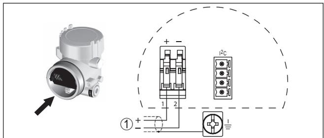
Fig. 15: Esquema de conexión - Carcasa de dos cámaras
