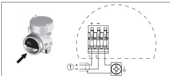
Fig. 19: Esquema de conexión con carcasa de dos cámaras EX-d-ia
