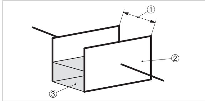
Fig. 3: Principio de funcionamiento - Condensador de placas
