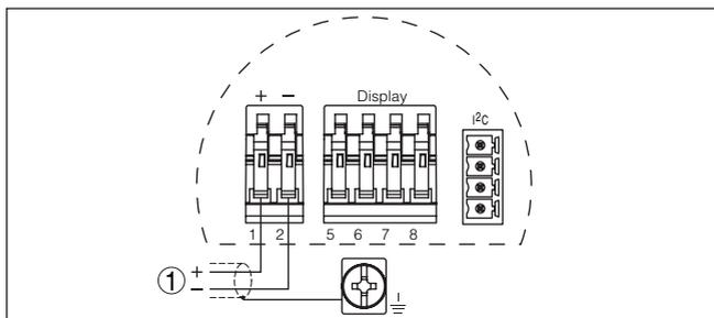
Fig. 11: Esquema de conexión . Carcasa de una cámara
