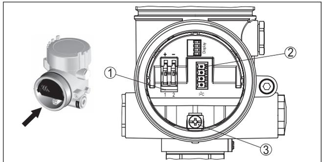
Fig. 14: Compartimiento de conexiones - Carcasa de dos cámaras
