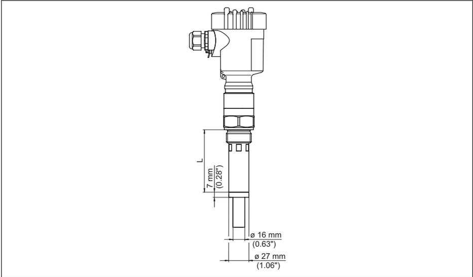
Abb. 35: VEGACAL 62, Abschirmrohr z. B. gegen starke Kondensatbildung
