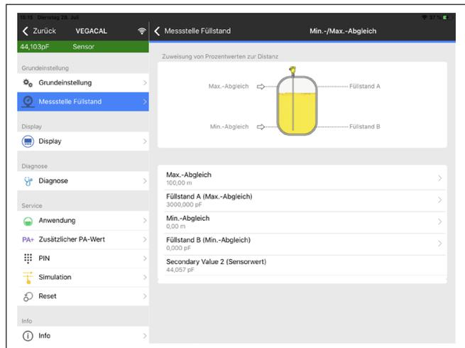
Abb. 27: Beispiel einer App-Ansicht - Inbetriebnahme Sensorabgleich
