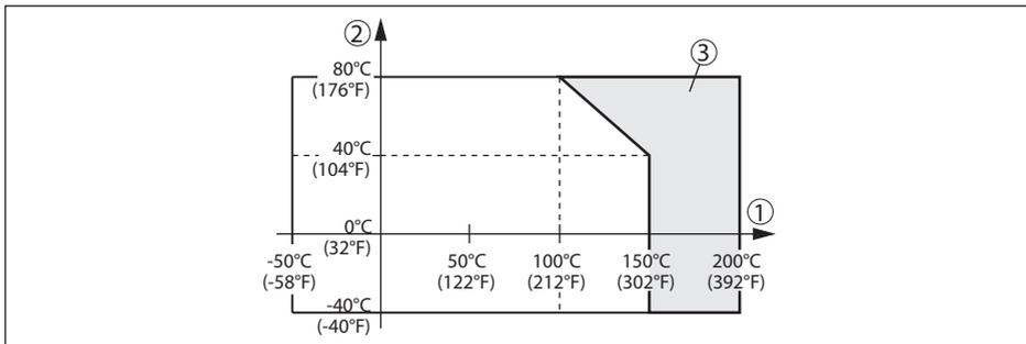
Abb. 28: Umgebungstemperatur - Prozesstemperatur
