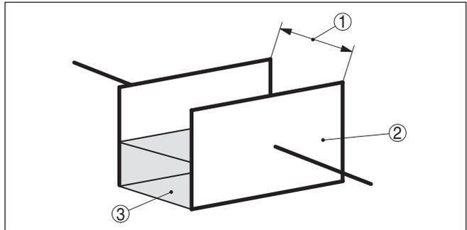
Abb. 3: Funktionsprinzip - Plattenkondensator
