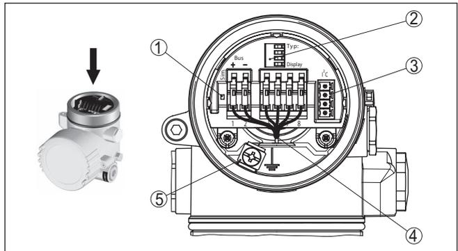
Abb. 13: Elektronikraum - Zweikammergehäuse
