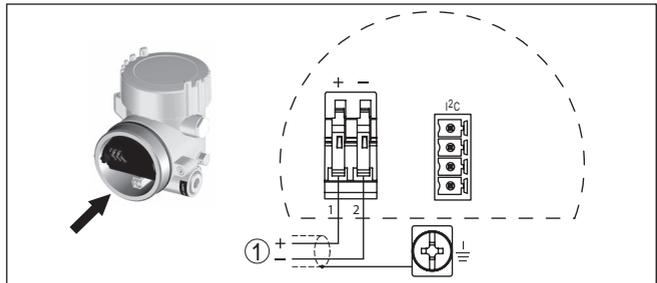
Abb. 15: Anschlussplan - Zweikammergehäuse
