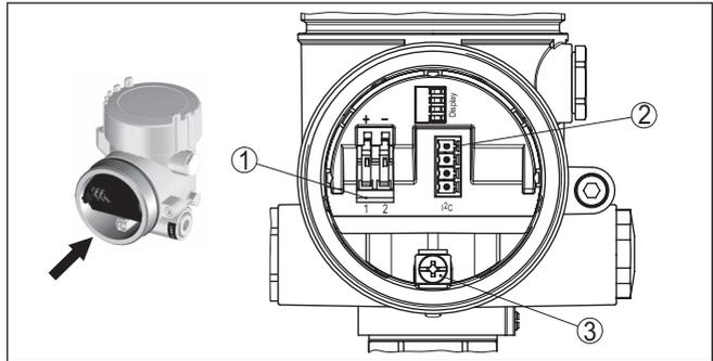
Abb. 14: Anschlussraum - Zweikammergehäuse
