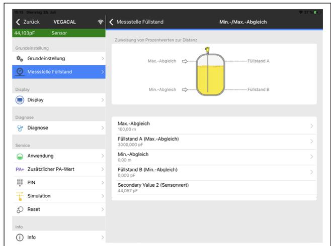
Abb. 28: Beispiel einer App-Ansicht - Inbetriebnahme Sensorabgleich
