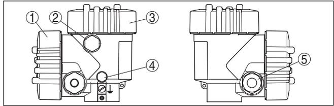
Abb. 16: Zweikammergehäuse
