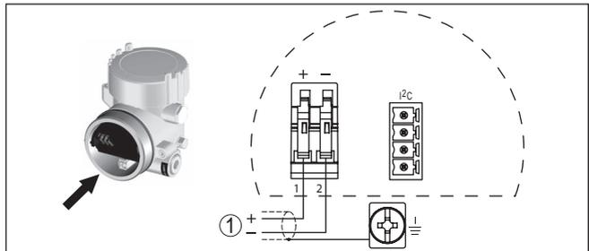
Abb. 15: Anschlussplan - Zweikammergehäuse
