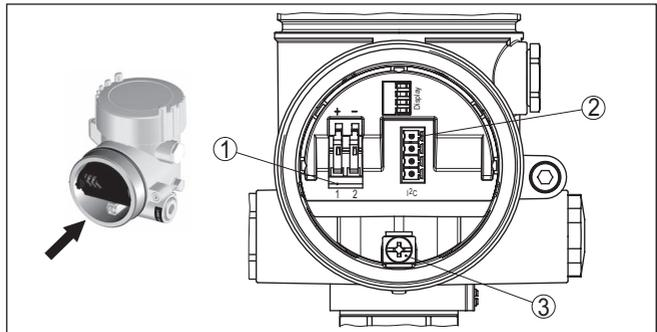
Abb. 14: Anschlussraum - Zweikammergehäuse
