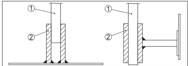
Abb. 6: Messsonde fixieren
