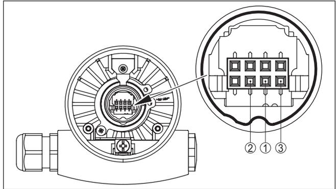
插图. 29: 检查测量探头内的电阻
