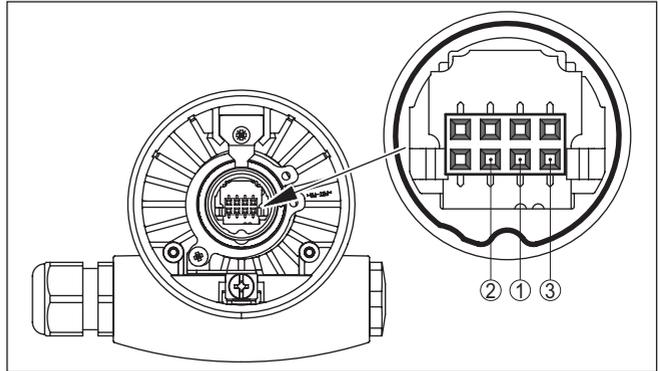
插图. 29: 检查测量探头内的电阻
