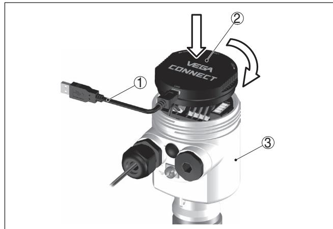
插图. 23: 通过接口适配器 VEGACONNECT 将电脑直接与传感器相连
