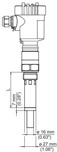
插图. 35: VEGACAL 66, 屏蔽管, 如用于防止冷凝水大量积聚
