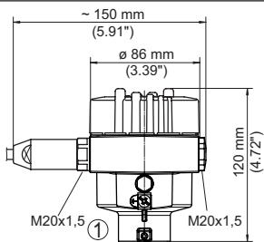
插图. 33: 采用保护等级达 IP66/IP68 (1 bar) 的壳体版本 (内装显示和调整模块后, 壳体高度增加了18 mm/0.71 in)
