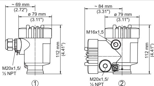
插图. 32: 采用防护等级为 IP66/IP67 的外壳版本 (内装显示和调整模块后, 外壳高度增加了 9 mm/0.35 in)
