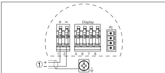
Figura 11: Schema di allacciamento - custodia a una camera
