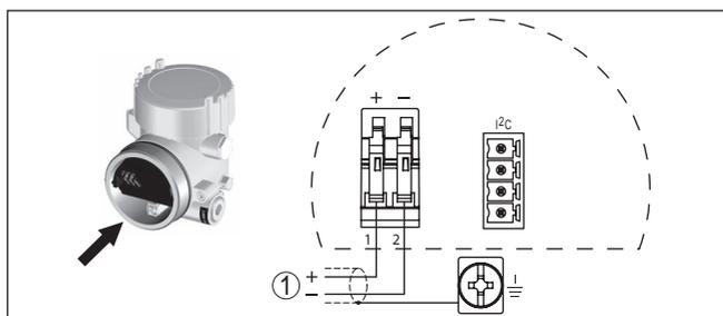
Figura 15: Schema di allacciamento - custodia a due camere
