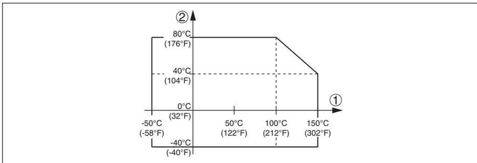
Figura 30: Temperatura ambiente - Temperatura di processo
