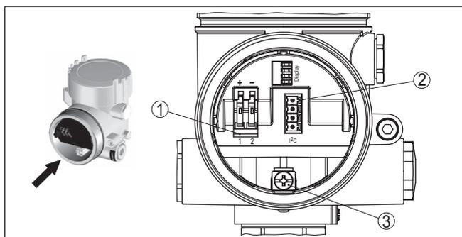
Figura 14: Vano di allacciamento - custodia a due camere
