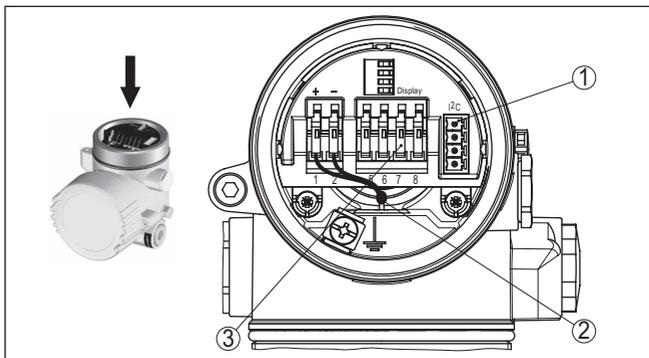
Figura 17: Vano dell'elettronica - custodia a due camere
