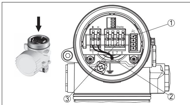
Figura 13: Vano dell'elettronica - custodia a due camere
