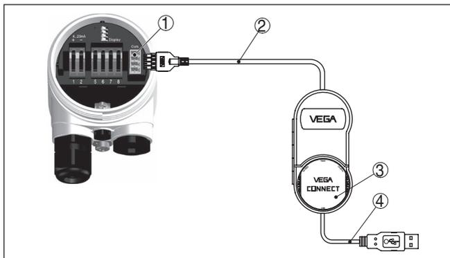
Figura 24: Allacciamento tramite adattatore d'interfaccia VEGACONNECT esterno
