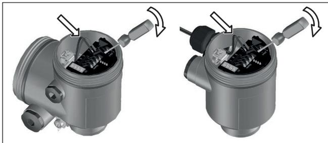
Figura 8: Operazioni di collegamento 6 e 7
