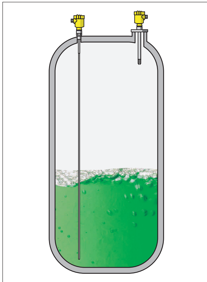
Rys. 2: Wykrywanie poziomu granicznego rozpuszczalnika w zbiorniku
