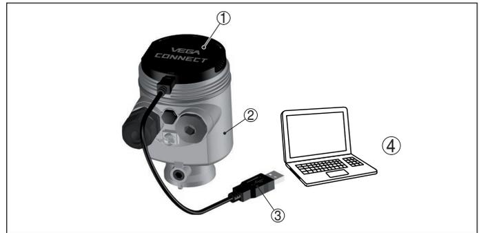
Fig. 27: Conexión del PC via VEGACONNECT y USB
