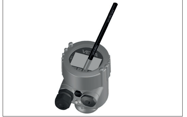
Res. 16: Gösterge ve ayar modülü - Manyetik pimden kumanda ile
