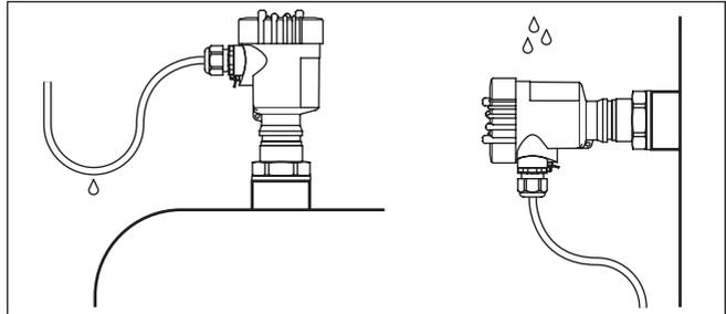
Abb. 5: Maßnahmen gegen das Eindringen von Feuchtigkeit
