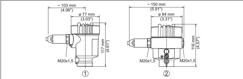
Abb. 18: Gehäuseausführungen in Schutzart IP66/IP68, 1 bar
