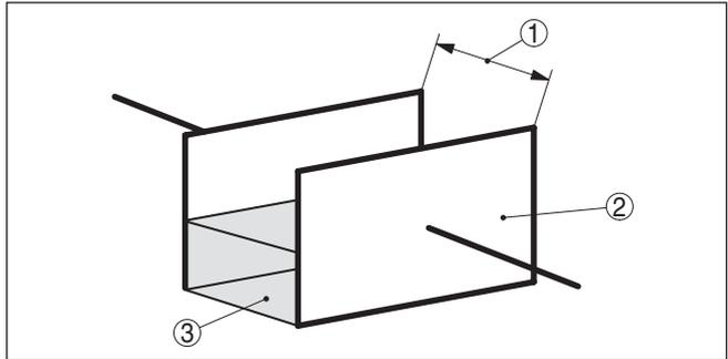
Abb. 3: Funktionsprinzip - Plattenkondensator
