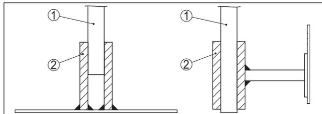
Abb. 6: Messsonde fixieren
