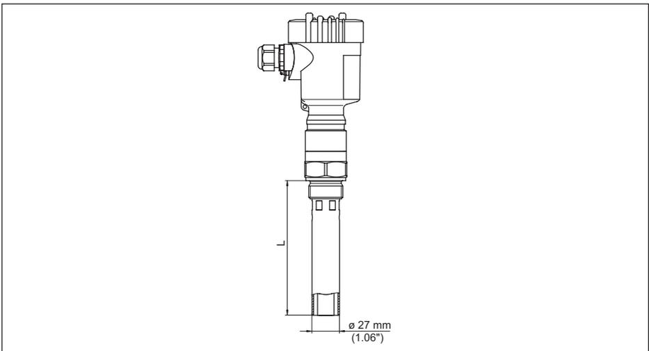
Abb. 21: VEGACAL 63, Hüllrohr z. B. bei kleiner Dielektrizitätszahl oder zur Linearisierung
