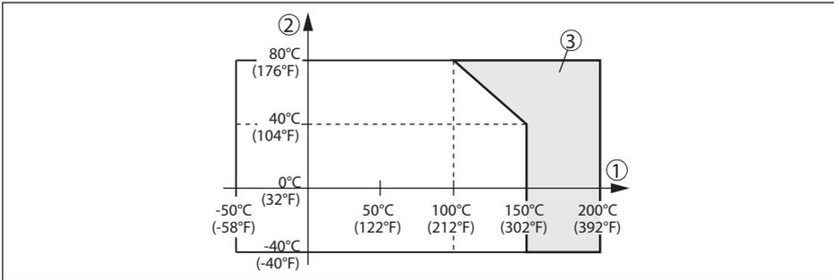
Abb. 15: Umgebungstemperatur - Prozesstemperatur
