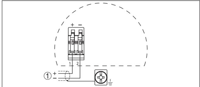
Abb. 11: Anschlussplan - Einkammergehäuse
