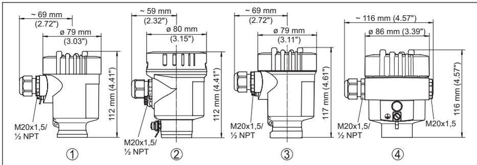
Abb. 17: Gehäuseausführungen in Schutzart IP66/IP67 und IP66/IP68; 0,2 bar
