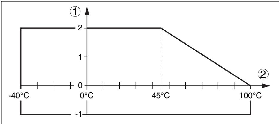
Abb. 14: Prozessdruck - Prozesstemperatur (Flansch aus PTFE)
