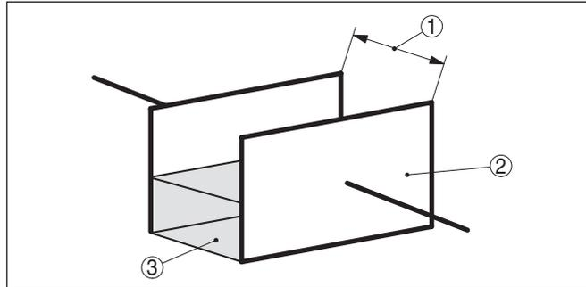
Abb. 3: Funktionsprinzip - Plattenkondensator
