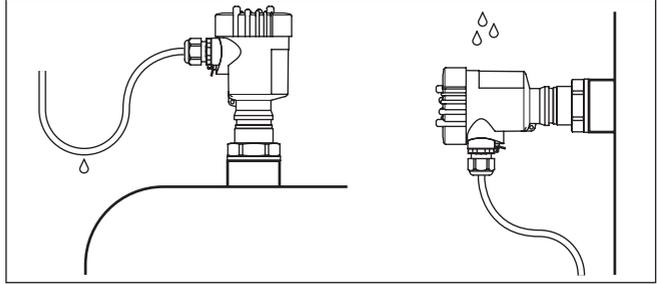
Abb. 4: Maßnahmen gegen das Eindringen von Feuchtigkeit
