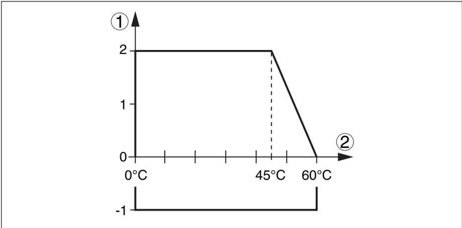
Abb. 15: Prozessdruck - Prozesstemperatur (Flansch aus PP)
