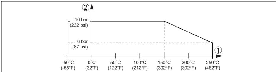
Abb. 16: Prozessdruck - Prozesstemperatur
