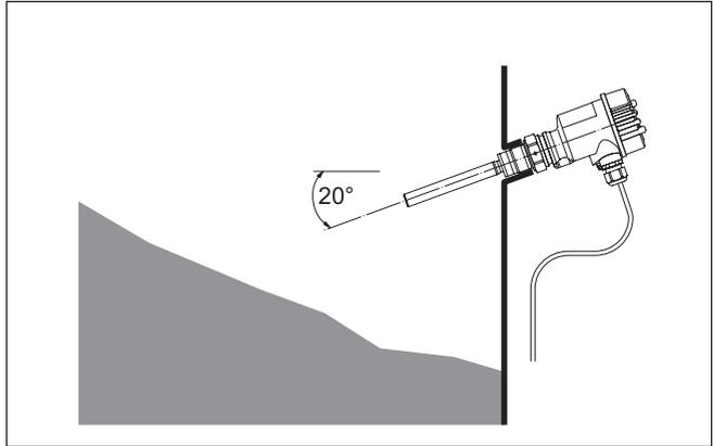
Abb. 6: Waagerechte Montage
