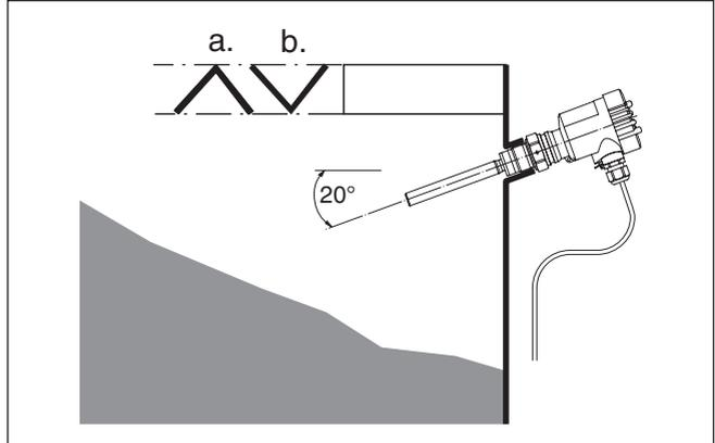
Abb. 3: Waagerechter Einbau
