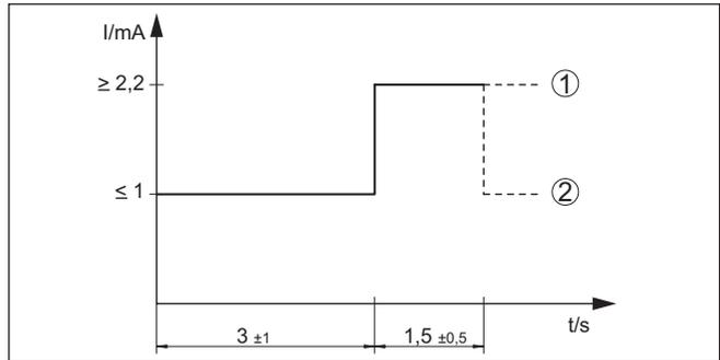
Abb. 14: Ablaufdiagramm des Funktionstests - Schaltfunktion entsprechend Bedeckungszustand und Kennlinienauswahl (siehe Funktionstabelle)
