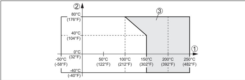
Abb. 17: Umgebungstemperatur - Prozesstemperatur
