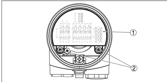
Abb. 15: Halteschrauben lösen
