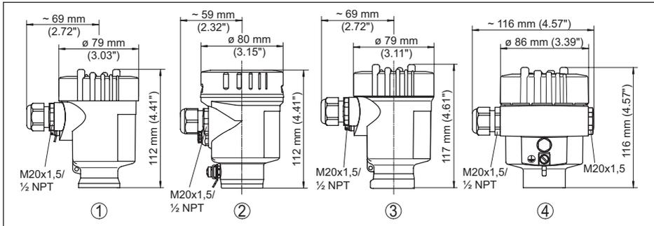
Abb. 18: Gehäuseausführungen in Schutzart IP66/IP67 und IP66/IP68; 0,2 bar
