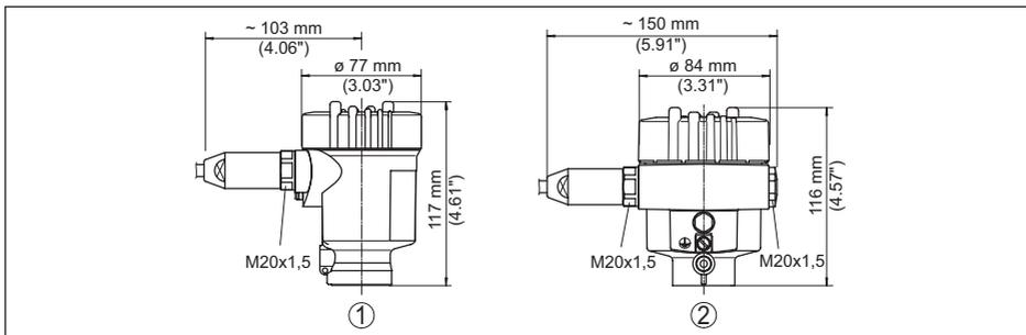
Abb. 19: Gehäuseausführungen in Schutzart IP66/IP68 (1 bar)
