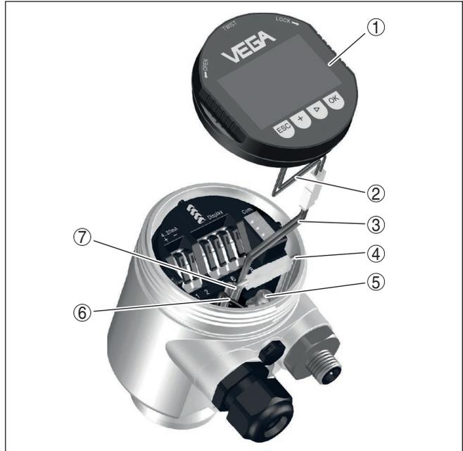
插图. 3: 在插座壳体中传感器的连接
