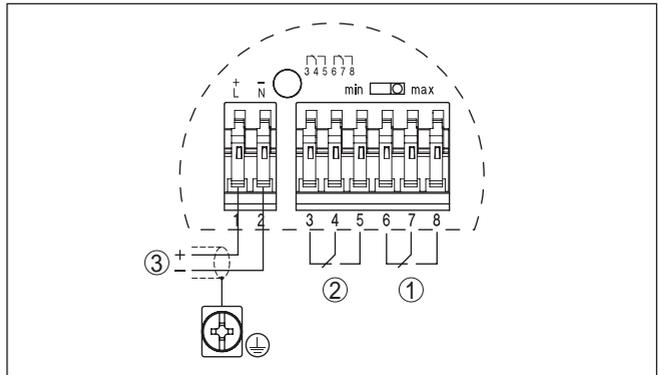
Fig. 10: Wiring plan
