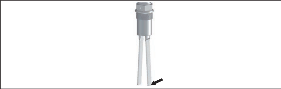
Fig. 29: Maximale zijwaartse belasting op de langszijde van de vork (smalle vorkzijde)
