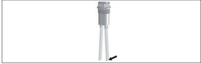
Res. 29: Çatal kenarı boyunca maksimum yanal yük (İnce çatal kenarı)
