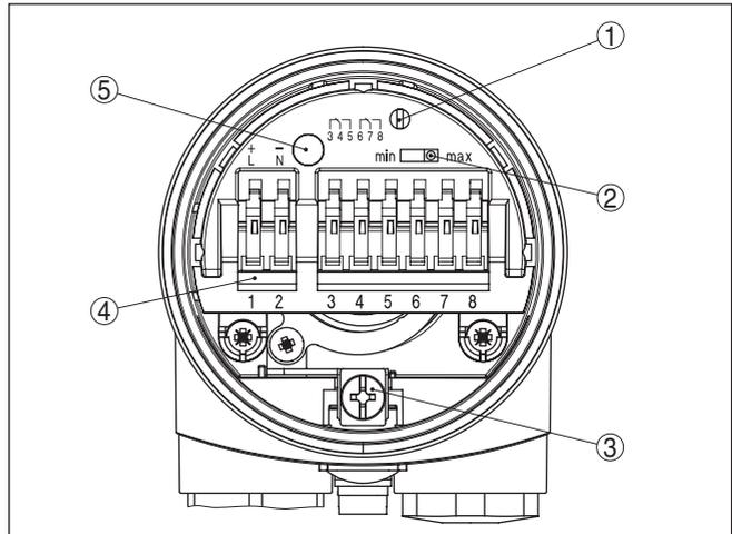
Fig. 11: Compartiment électronique et de raccordement - sortie relais
