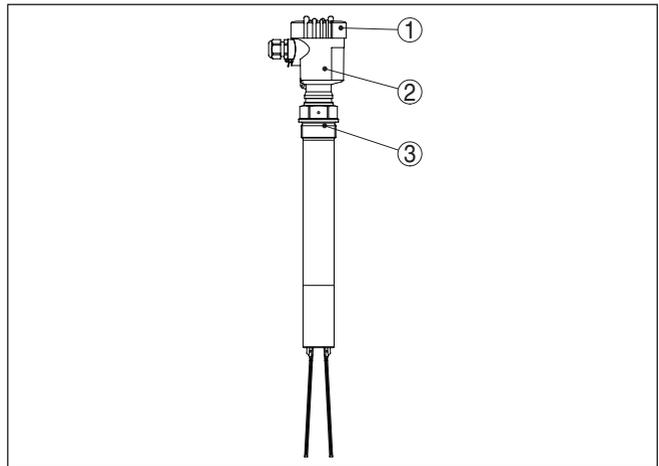
Fig. 1: VEGAWAVE 63 avec boîtier en plastique
