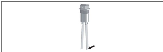
Fig. 13: Maximale zijwaartse belasting op de langszijde van de vork (smalle vorkzijde)
