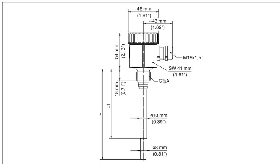
Figura 8: Sonda conduttiva a barra EL 1
