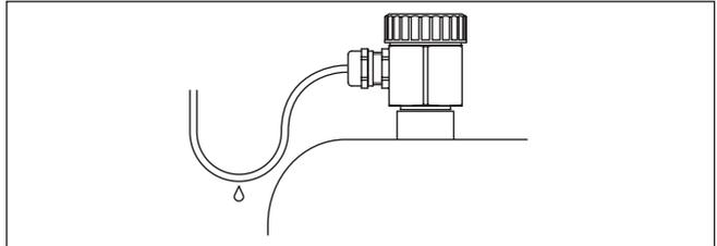
Abb. 2: Maßnahmen gegen das Eindringen von Feuchtigkeit
