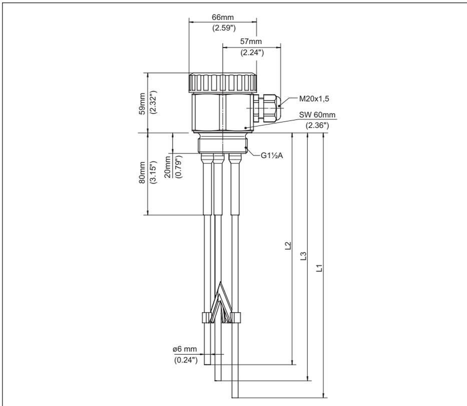
Abb. 7: Konduktive Mehrstabmesssonde EL 3
