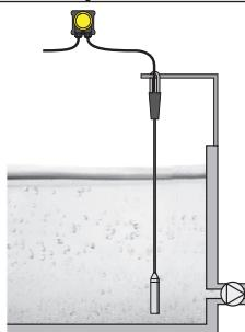
Abb. 30: Ejemplo de montaje: VEGAWELL S 51 en un estanque abierto con carcasa compensadora de presión VEGABOX 03
