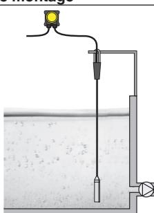
Abb. 21: Exemple de montage : VEGAWELL S 51 dans un bassin ouvert avec boîtier de compensation de pression VEGABOX 03
