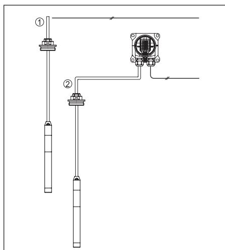
Abb. 6: Anschluss des VEGAWELL S 51 an die Spannungsversorgung
