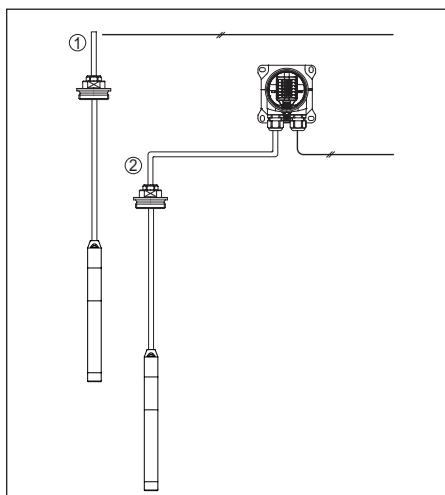
Abb. 24: Raccordement du VEGAWELL S 51 à l'alimentation
