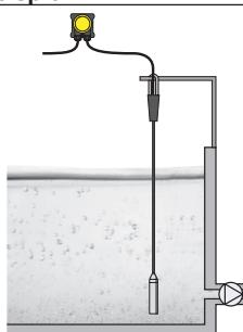
Abb. 3: Montagebeispiel: VEGAWELL S 51 in einem offenen Becken mit Druckausgleichsgehäuse VEGA-BOX 03
