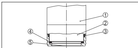
Abb. 2: Frontbündiger Einbau der CERTEC®-Messzelle mit Doppeldichtung
