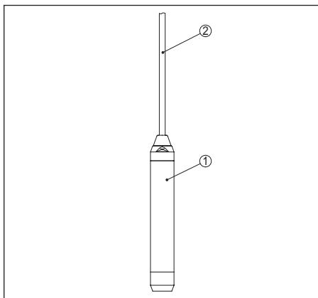
Abb. 1: Beispiel eines VEGA WELL S 51 mit Verschraubung
