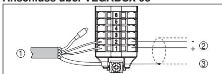
Abb. 8: Anschlussplan VEGA WELL S 51 4 ... 20 mA, 4 ... 20 mA/HART
