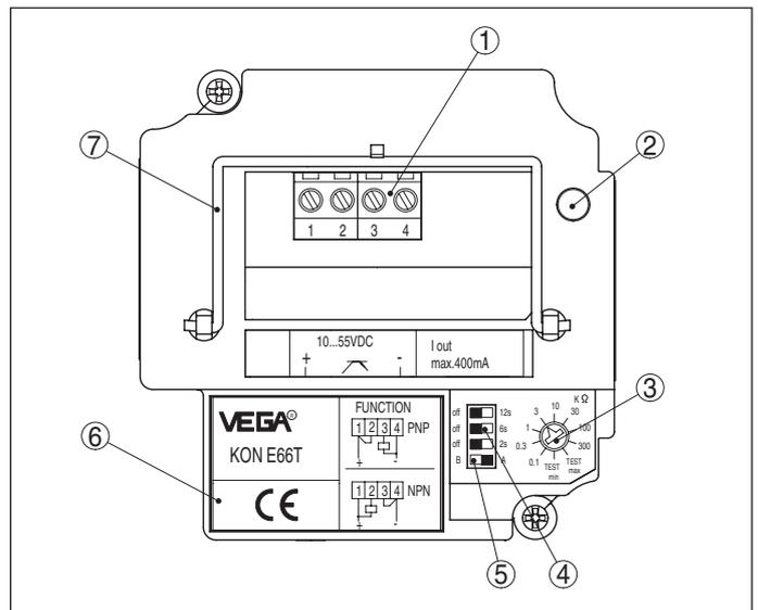
Abb. 17: Elektronikeinsatz VEGAKON 66 T (Transistorausgang)
