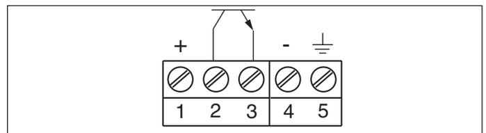
Abb. 9: VEGAKON 61 - Transistorausgang
