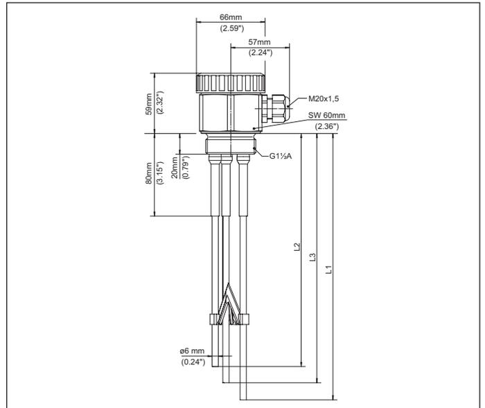
Abb. 22: Konduktive Mehrstabmesssonde EL 3
