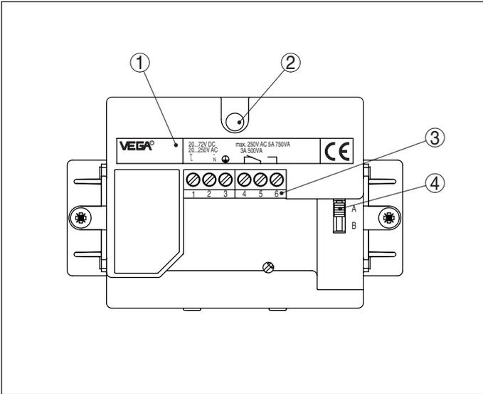
Abb. 14: Elektronikeinsatz VEGAKON 61 R (Relaisausgang)
