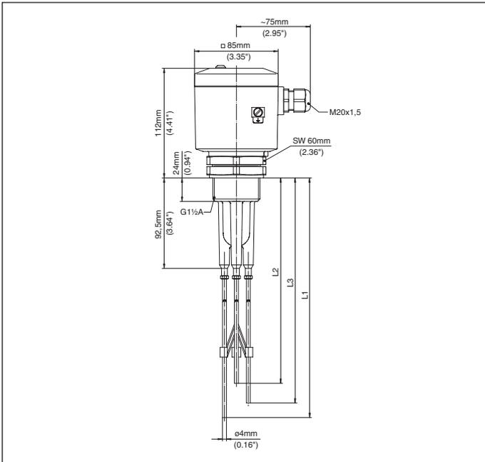
Abb. 20: VEGAKON 66 mit drei Elektroden
