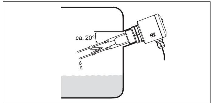
Abb. 6: Waagerechte Montage
