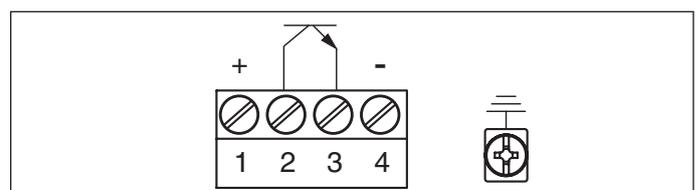
Abb. 10: VEGAKON 66 - Transistorausgang
