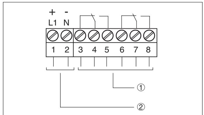
Abb. 8: VEGAKON 66 - Elektronik mit Relaisausgang
