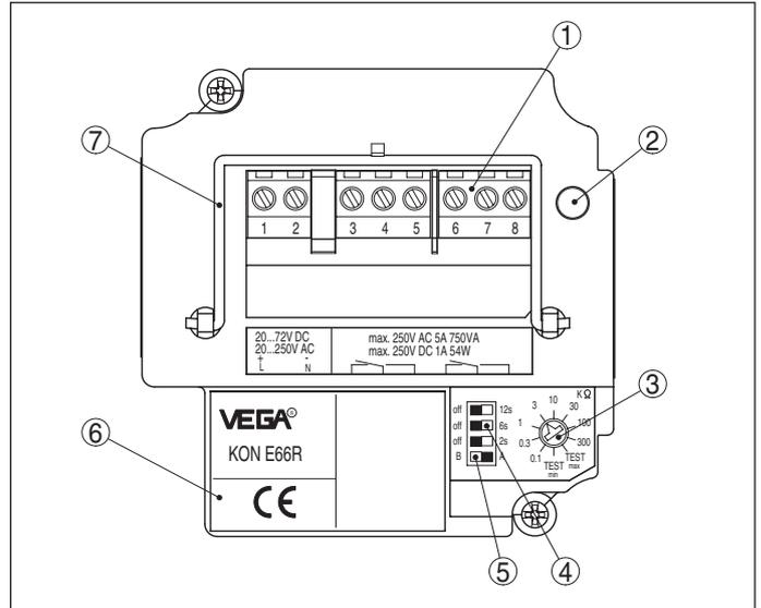
Abb. 16: Elektronikeinsatz VEGAKON 66 R (Relaisausgang)
