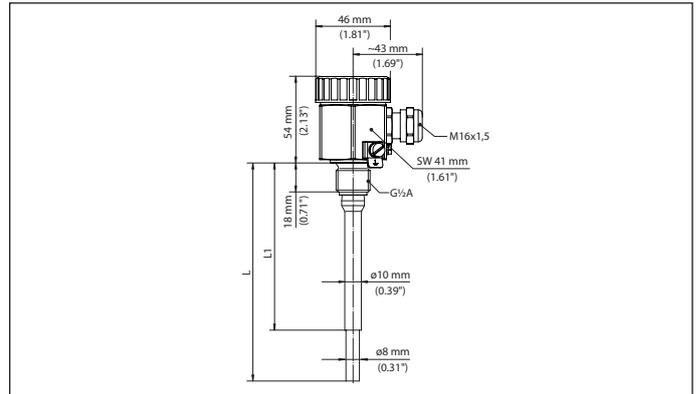
Abb. 21: Konduktive Stabmesssonde EL 1
