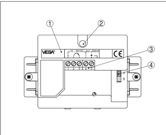
Abb. 15: Elektronikeinsatz VEGAKON 61 T (Transistorausgang)
