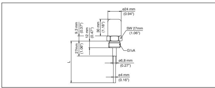
插图. 25: EL 8 型导电式棒型测量探头
