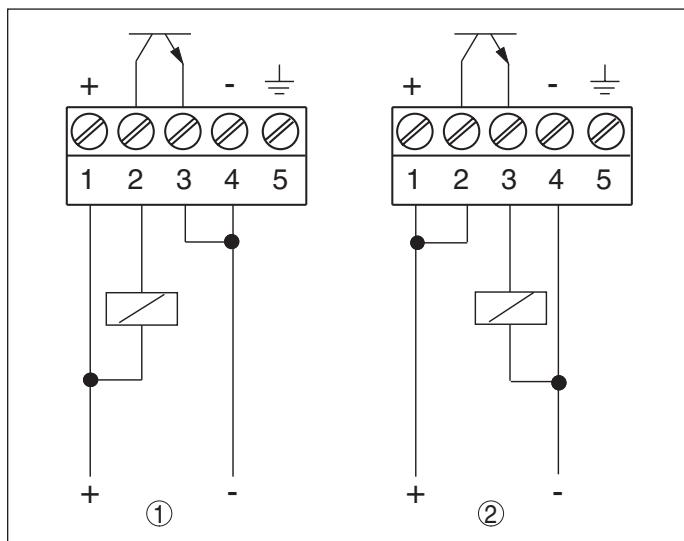
插图. 11: VEGAKON 61 - 带有晶体管输出口的电子部件
