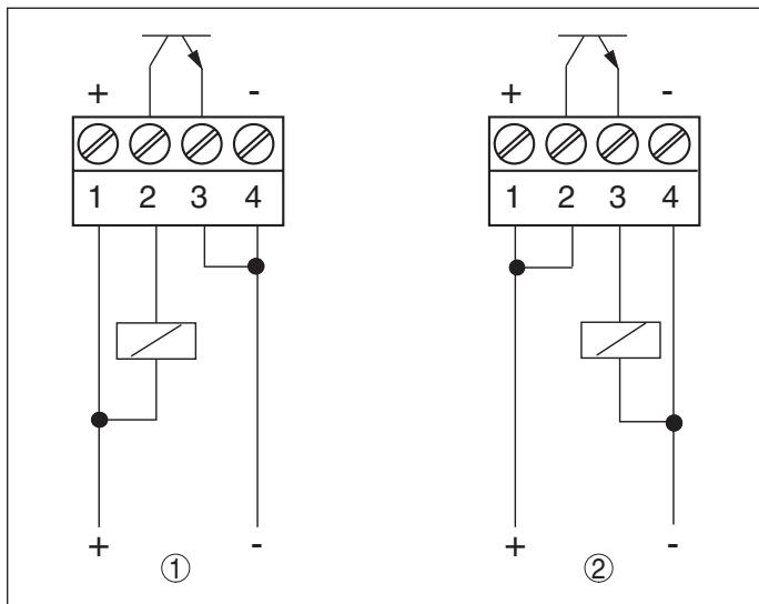
插图. 12: VEGAKON 66 - 带有晶体管输出口的电子部件
