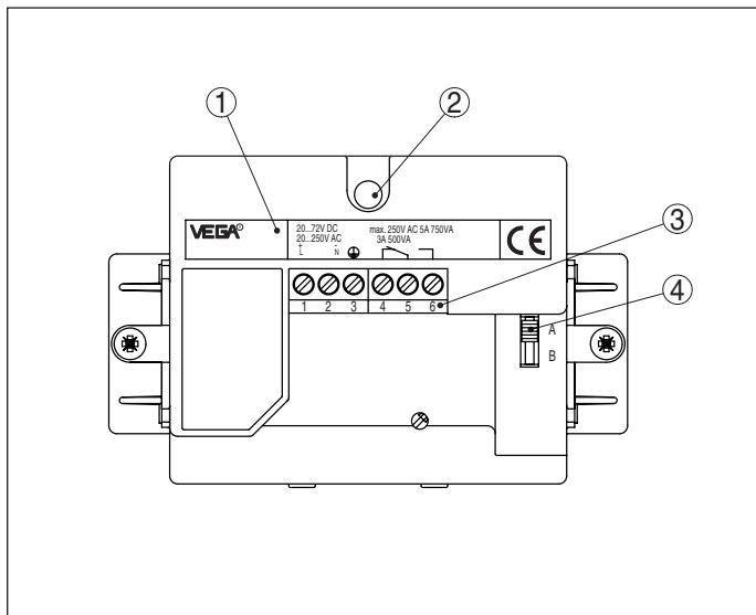
插图. 14: 电子插件 VEGAKON 61 R (继电器输出口)
