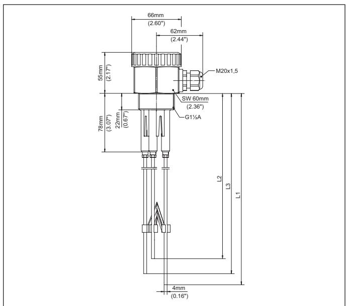
插图. 23: EL 4 型导电式多棒型测量探头
