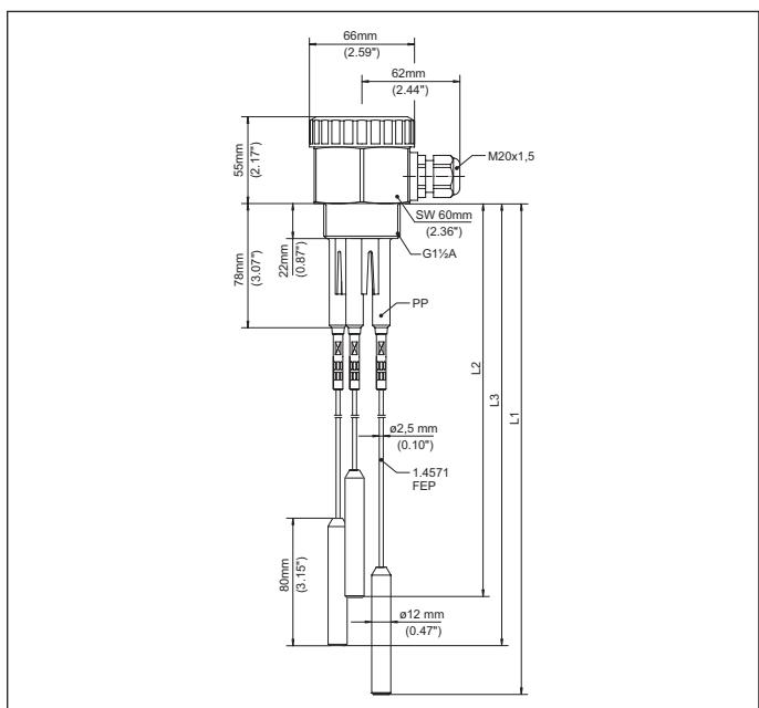
插图. 24: EL 6 型导电式多棒型测量探头
