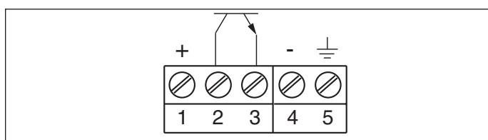
插图. 9: VEGAKON 61 - 晶体管输出口
