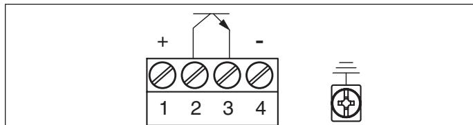
插图. 10: VEGAKON 66 - 晶体管输出口
