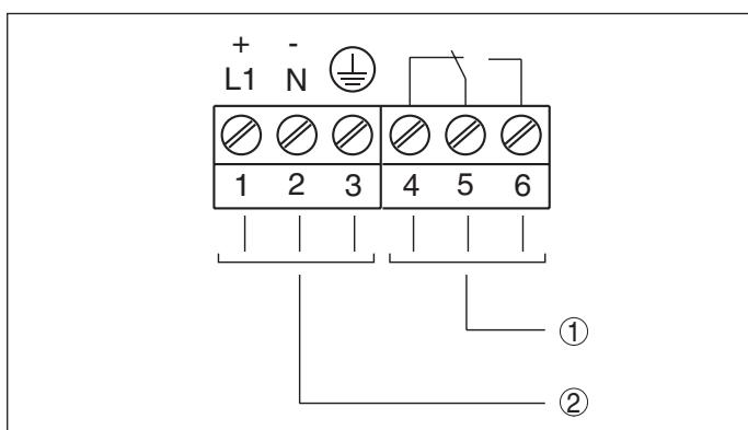
插图. 7: VEGAKON 61 - 带有继电器输出口的电子部件
