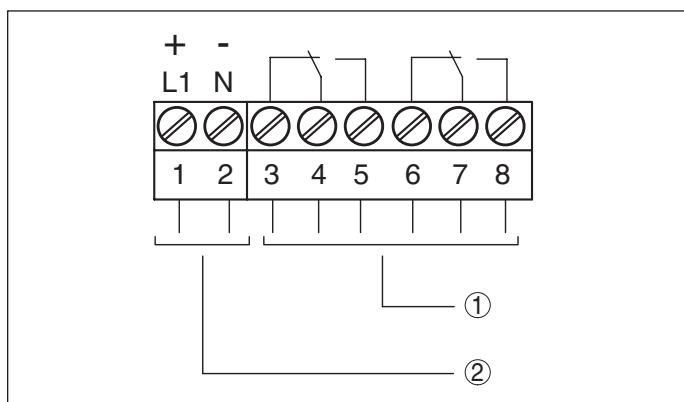
插图. 8: VEGAKON 66 - 带有继电器输出口的电子部件
