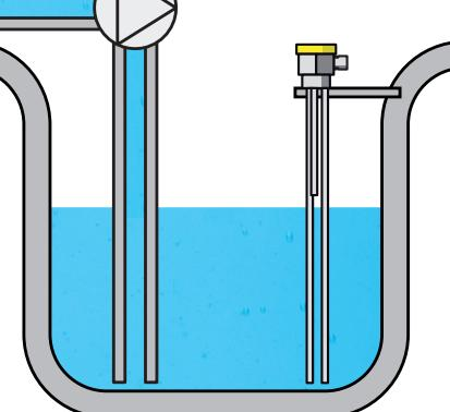
插图. 2: 用一个导电式测量探头 EL 3 来控制泵
