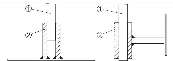
插图. 4: 将测量探头固定好
