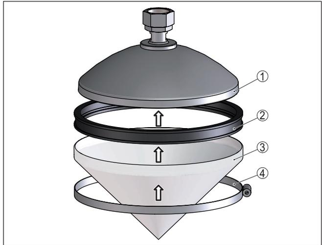
Abb. 10: Montage Antennenabdeckung
