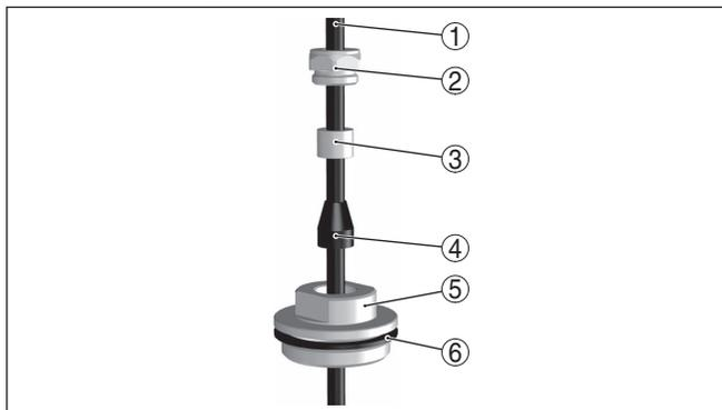
Figura 7: Struttura dell'attacco filettato del cavo portante
