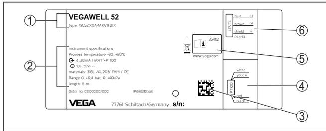
Figura 2: Struttura della targhetta d'identificazione (esempio)
