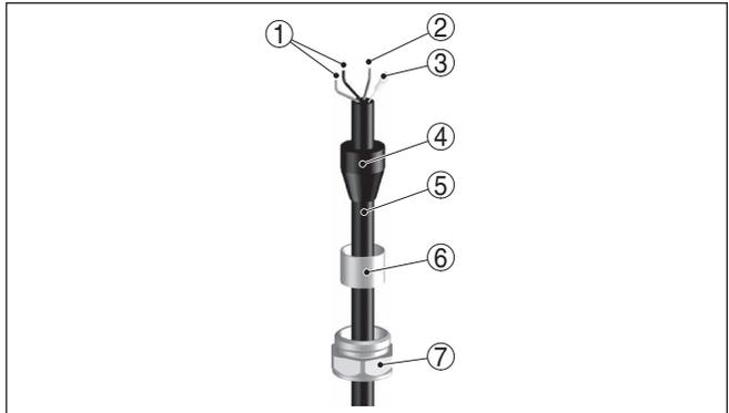
Figura 15: Struttura della guarnizione del cavo
