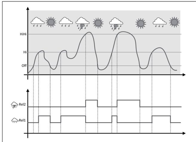
Abb. 19: Beispiel einer Pumpensteuerung mit Option "Schönwetterbetrieb"
