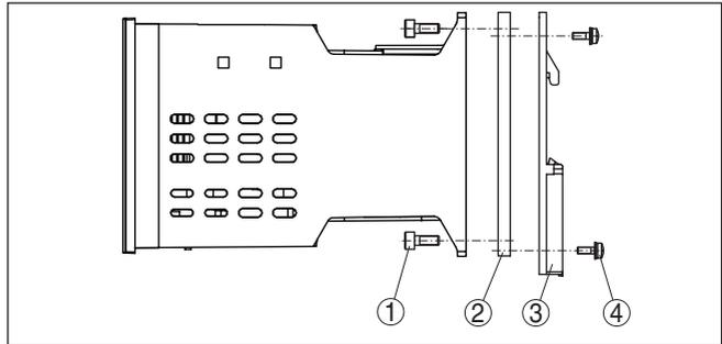
Abb. 4: Tragschienenmontage
