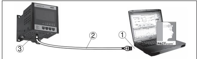
Abb. 8: Anschluss des PCs via USB
