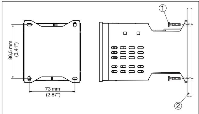
Abb. 3: Schraubmontage
