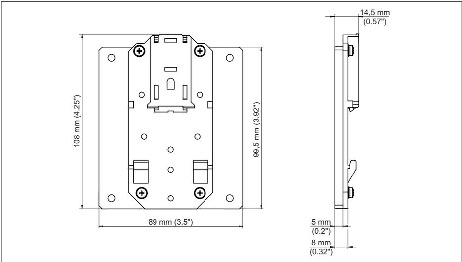
插图 24: 可选的支撑轨连接件的尺寸
