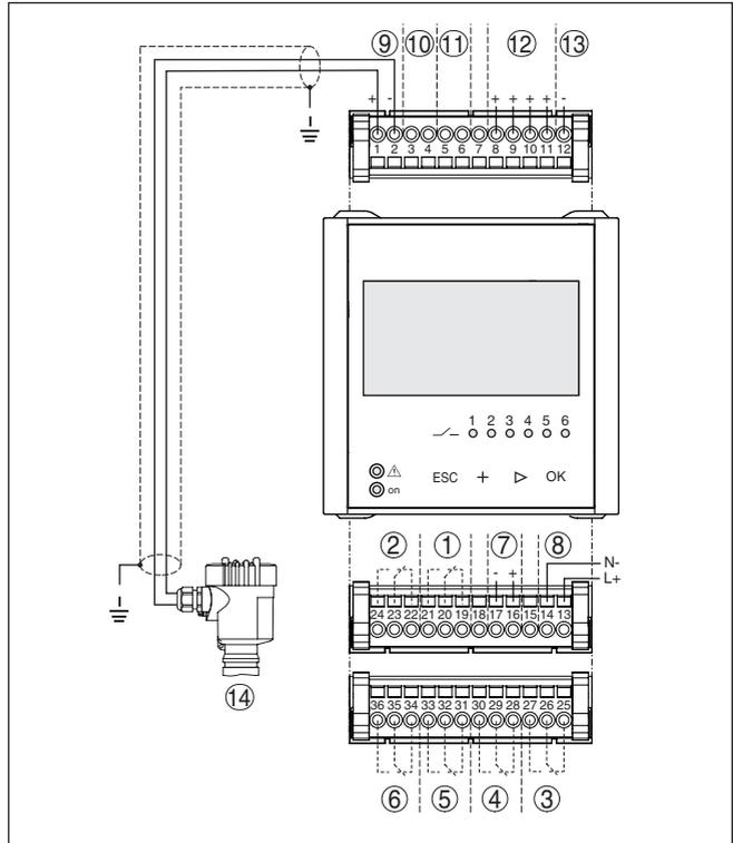
插图. 5: 带两线制传感器的接线图
