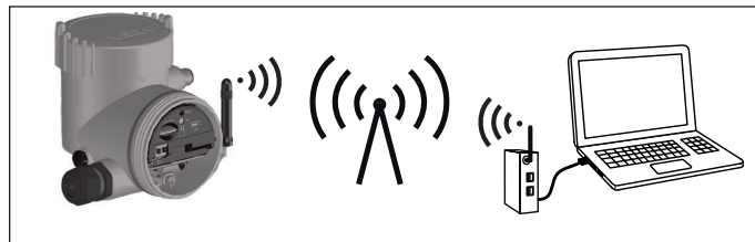
Rys. 42: Transmisja bezprzewodowa wartości pomiarowych i zdalne wprowadzanie parametrów do przyrządu za pośrednictwem sieci bezprzewodowej GSM
