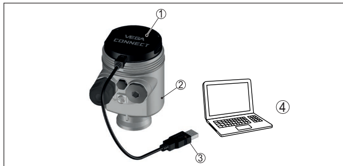
Rys. 36: Podłączenie PC poprzez VEGACONNECT i USB
