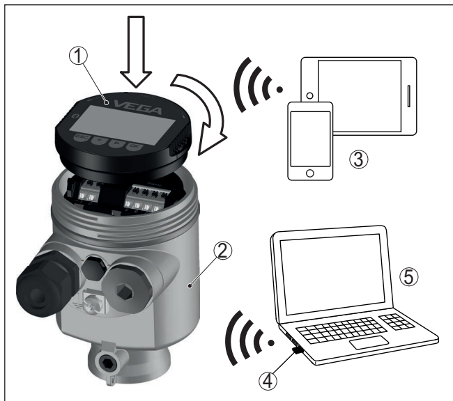
Abb. 2: Drahtlose Verbindung zu Standard-Bediengeräten
