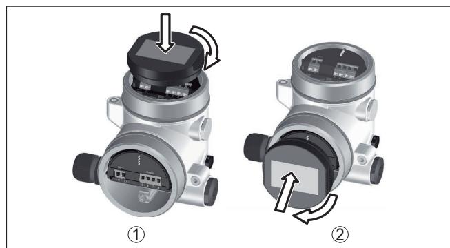
插图. 4: 将显示和调整模块装到双腔式壳体上
