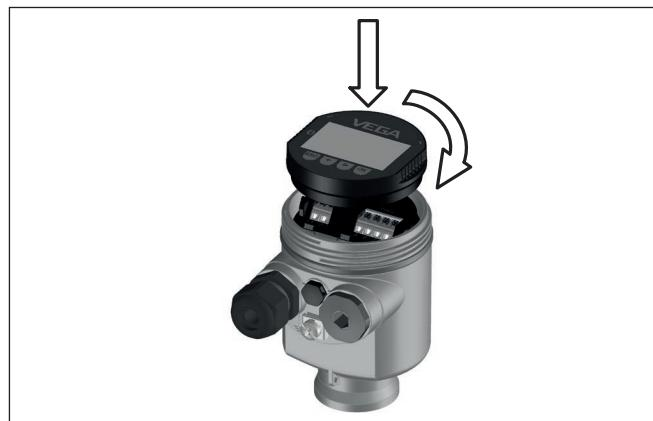
插图. 3: 将显示和调整模块装入单腔式壳体的电子部件腔中
