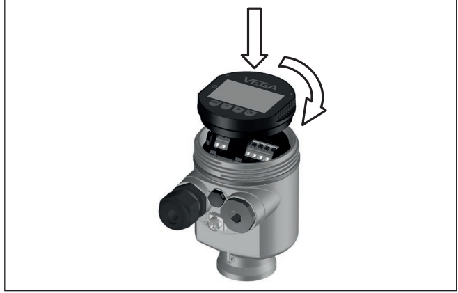
Res. 3: Elektronik bölümünde bir hücreli gövdede gösterge ve ayar modülünün çalıştırılması
