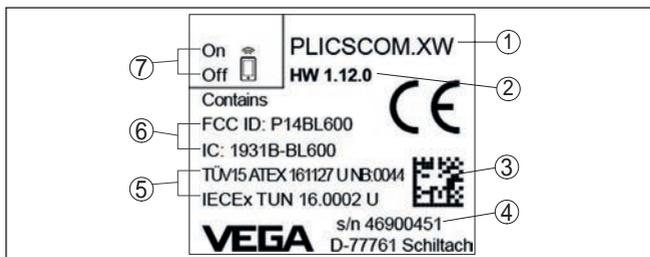
Figura 1: Struttura della targhetta d'identificazione (esempio)
