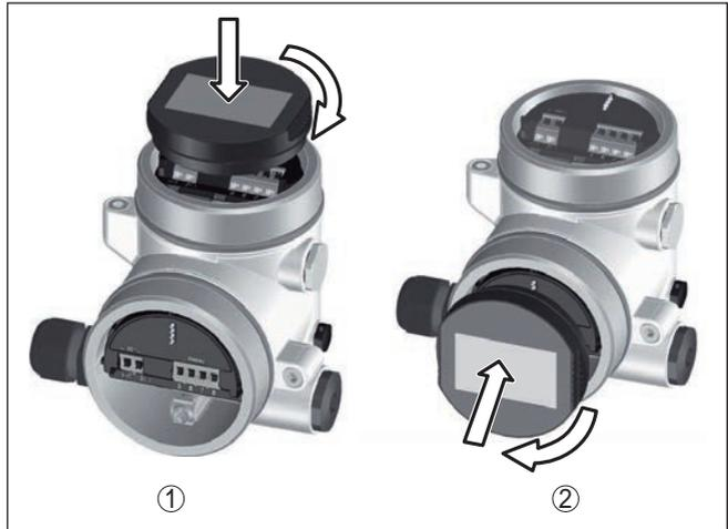
插图. 33: 将显示和调整模块装到双腔式壳体上
