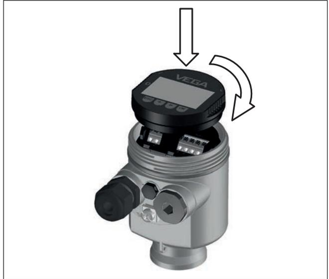
插图. 32: 将显示和调整模块装入单腔式壳体的电子部件腔中
