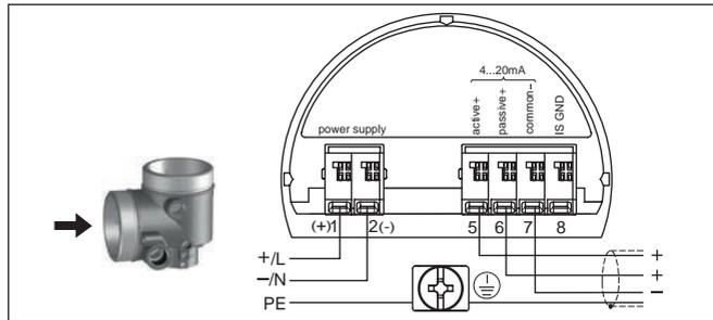
Abb. 25: Anschlussraum Zweikammergehäuse bei Netzspannung
