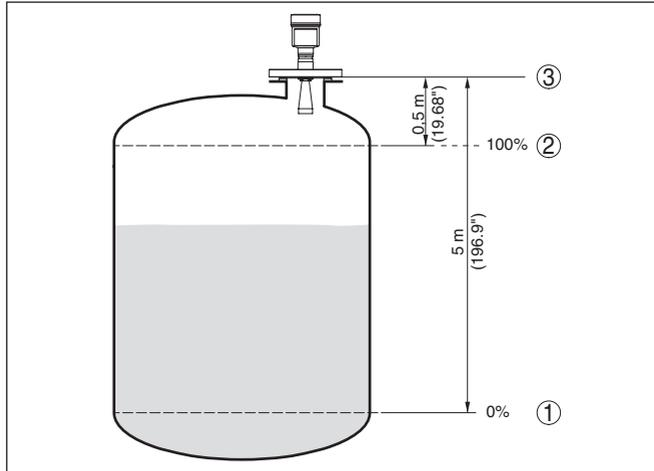
Abb. 33: Parametrierbeispiel Min./Max.-Abgleich
