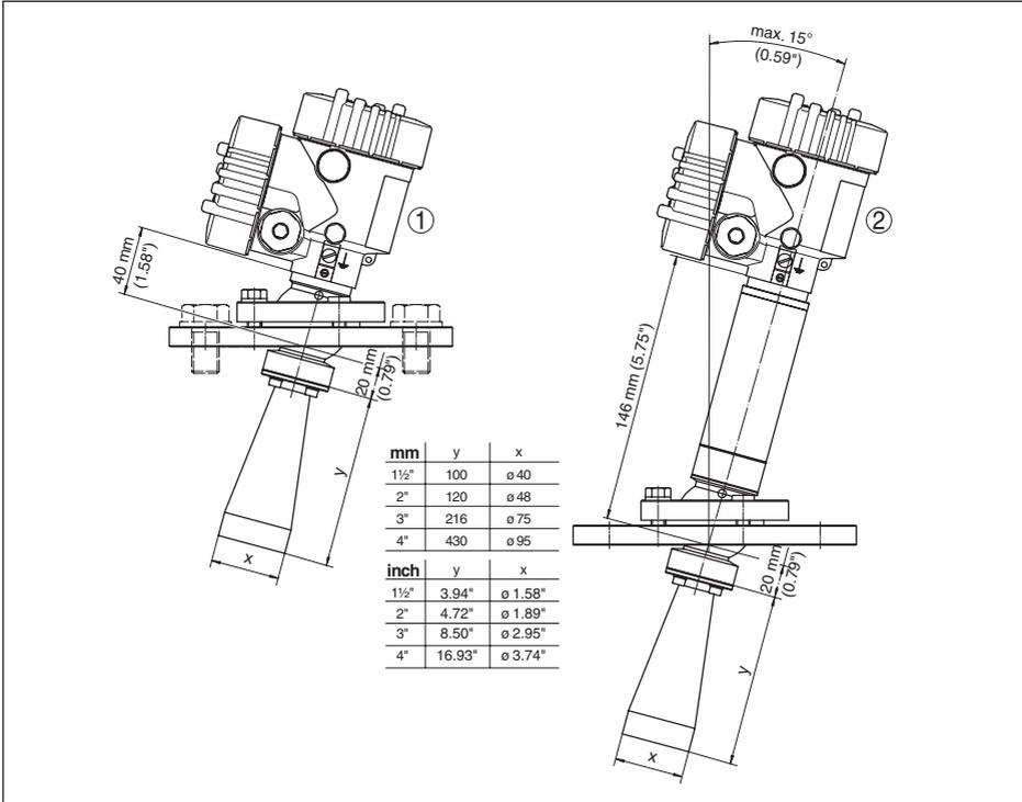
Abb. 59: VEGAPULS 62, Hornantenne und Schwenkhalterung
