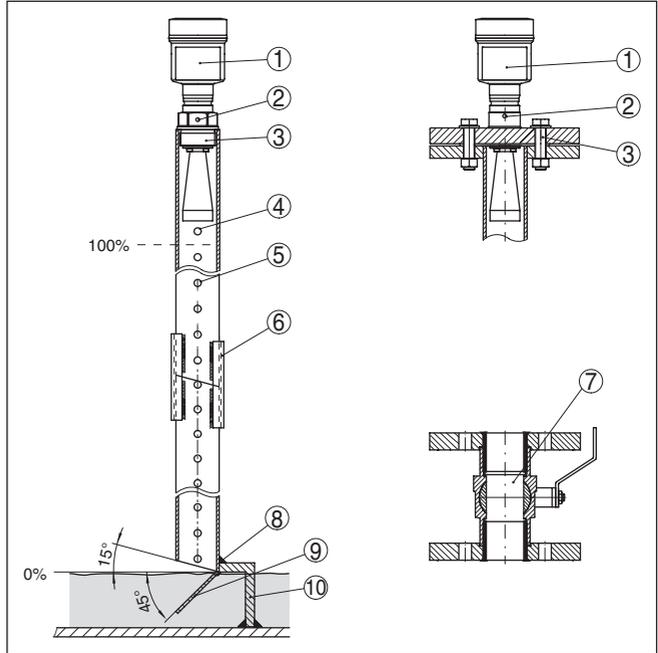
Abb. 18: Aufbau Schwallrohr VEGAPULS 62
