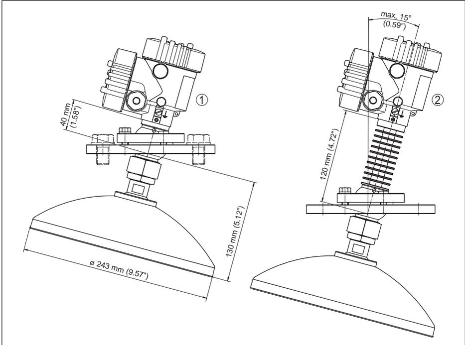
Abb. 61: VEGAPULS 62, Parabolantenne und Schwenkhalterung
