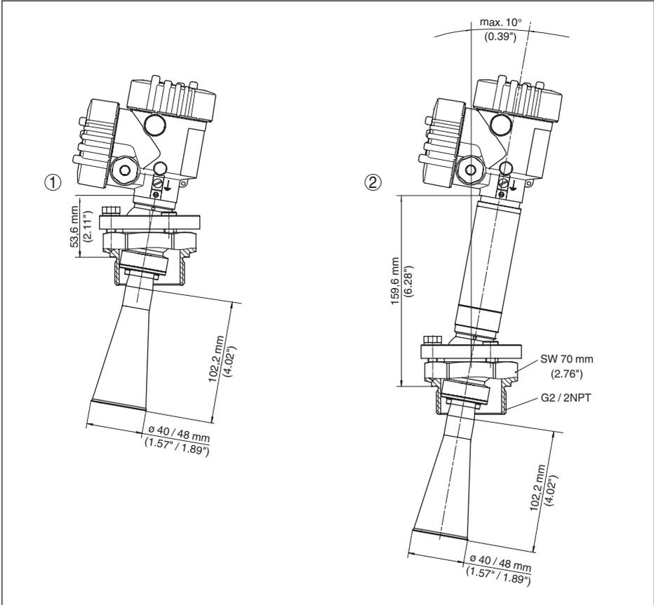
Abb. 60: VEGAPULS 62, Hornantenne und Schwenkhalterung, Gewindeanschluss
