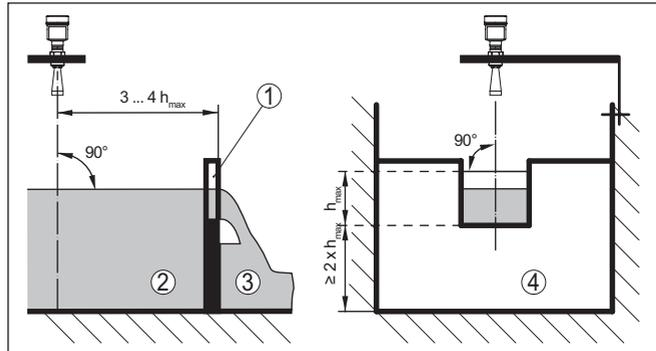
Abb. 21: Durchflussmessung mit Rechtecküberfall:  $d_{min}$  = Mindestabstand des Sensors (siehe Kapitel "Technische Daten");  $h_{max}$  = max. Befüllung des Rechtecküberfalls
