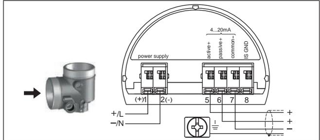
Abb. 26: Anschlussraum Zweikammergehäuse bei Kleinspannung
