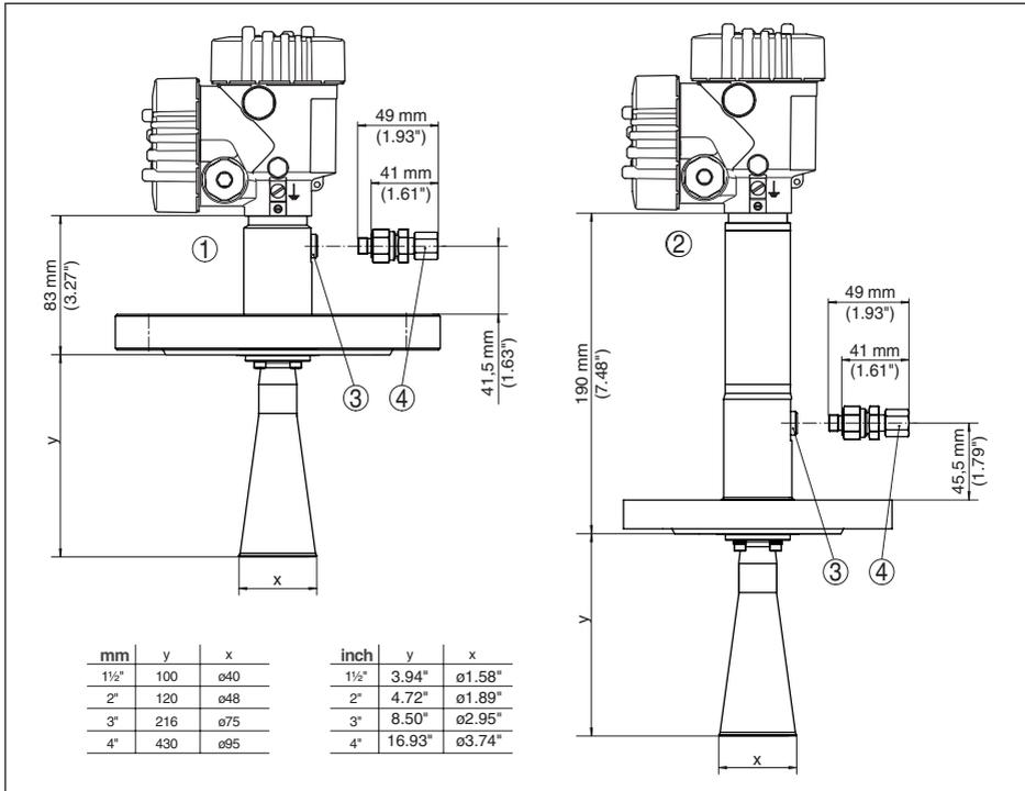
Abb. 57: VEGAPULS 62, Hornantenne in Flanschausführung mit Spülluftanschluss
