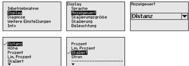
Die Werkseinstellung für den Anzeigewert ist z. B. bei Radarsensoren Distanz.
