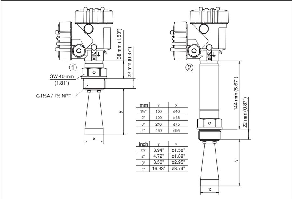
Abb. 55: VEGAPULS 62, Hornantenne in Gewindeausführung
