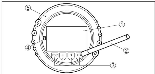
Abb. 32: Anzeige- und Bedienelemente - mit Bedienung über Magnetstift
