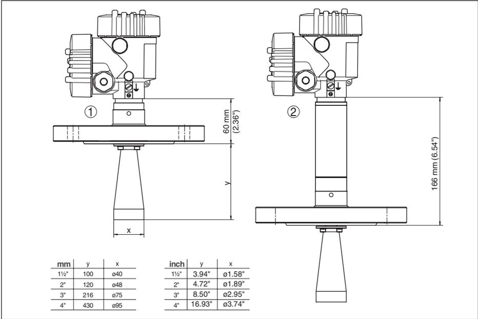
Abb. 56: VEGAPULS 62, Hornantenne in Flanschausführung
