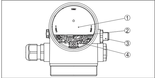
Abb. 27: Sicht auf den Elektronikraum mit VEGADIS-Adapter zum Anschluss der externen Anzeige- und Bedieneinheit
