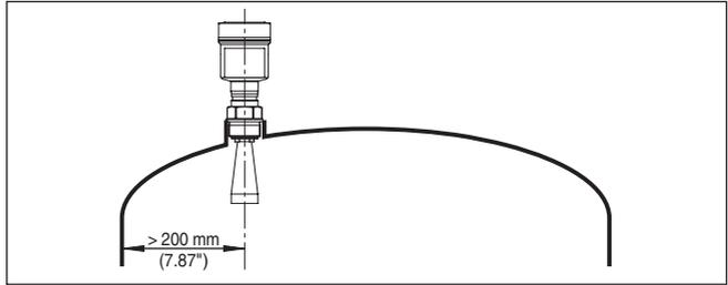
Abb. 5: Montage des Radarsensors an runden Behälterdecken
