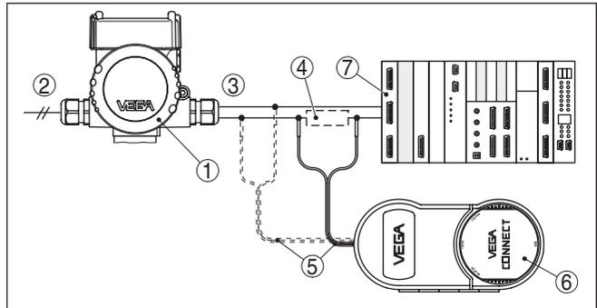
Abb. 35: Anschluss des PCs via HART an die Signalleitung
