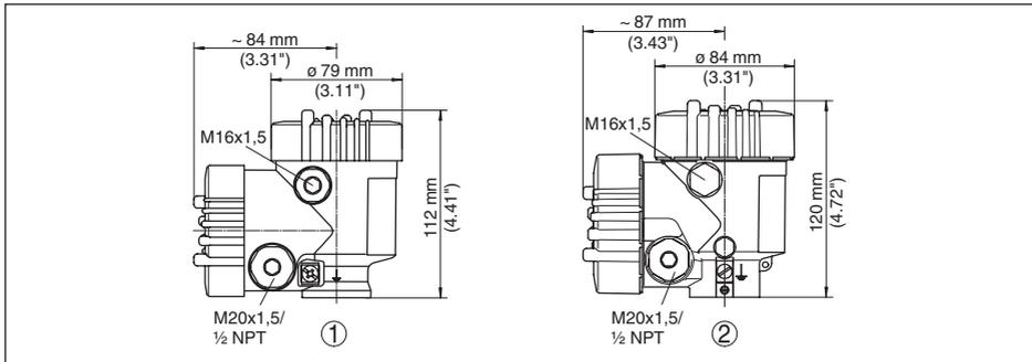
Abb. 54: Maße Gehäuse (mit eingebautem Anzeige- und Bedienmodul vergrößert sich die Gehäusehöhe um 9 mm/0.35 in, bei Metallgehäusen um 18 mm/0.71 in)
