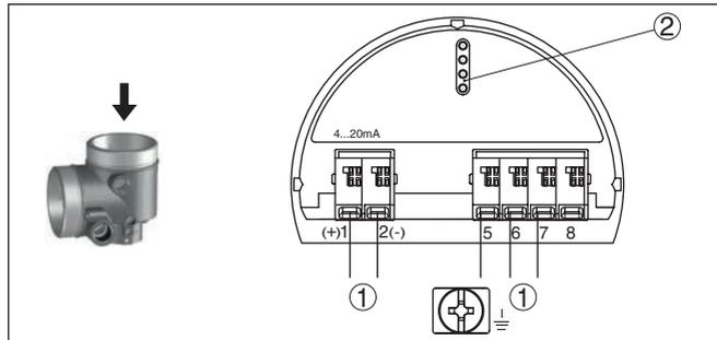
Abb. 24: Elektronikraum - Zweikammergehäuse
