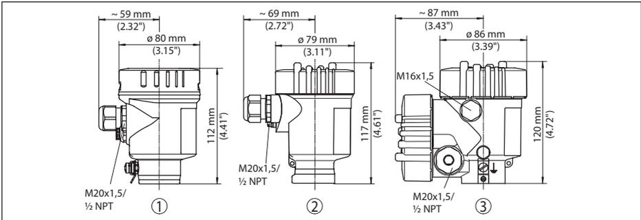
Abb. 35: Gehäuseausführungen in Schutzart IP 66/IP 68 (0,2 bar), (mit eingebautem Anzeige- und Bedienmodul vergrößert sich die Gehäusehöhe um 18 mm/0.71 in)
