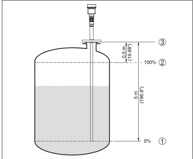
Abb. 18: Parametrierbeispiel Min.-/Max.-Abgleich
