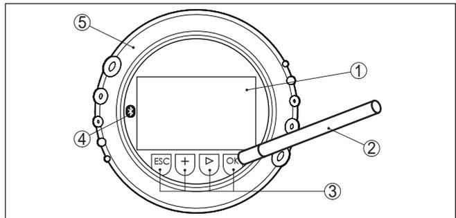
Abb. 17: Anzeige- und Bedienelemente - mit Bedienung über Magnetstift
