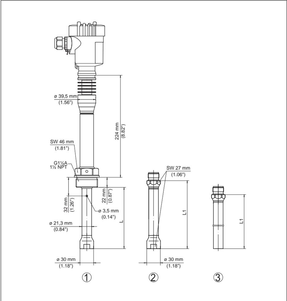
Abb. 39: VEGAPULS 62, Ausführung für Standrohrverlängerung mit Gewinde<sup>11)</sup>
