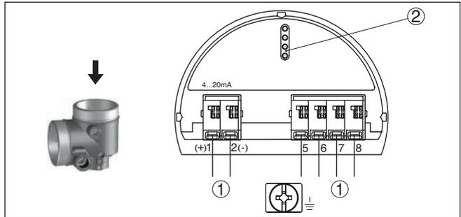
Abb. 5: Elektronikraum - Zweikammergehäuse
