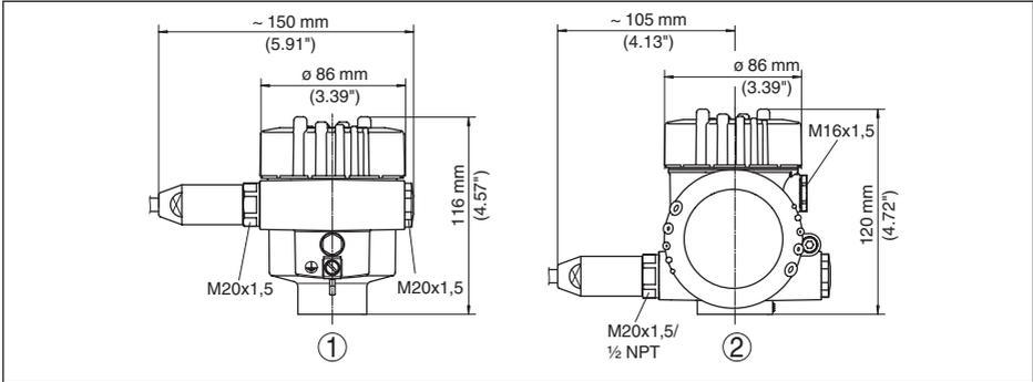
Abb. 34: Gehäuseausführungen in Schutzart IP 66/IP 68 (1 bar), (mit eingebautem Anzeige- und Bedienmodul vergrößert sich die Gehäusehöhe um 18 mm/0.71 in)
