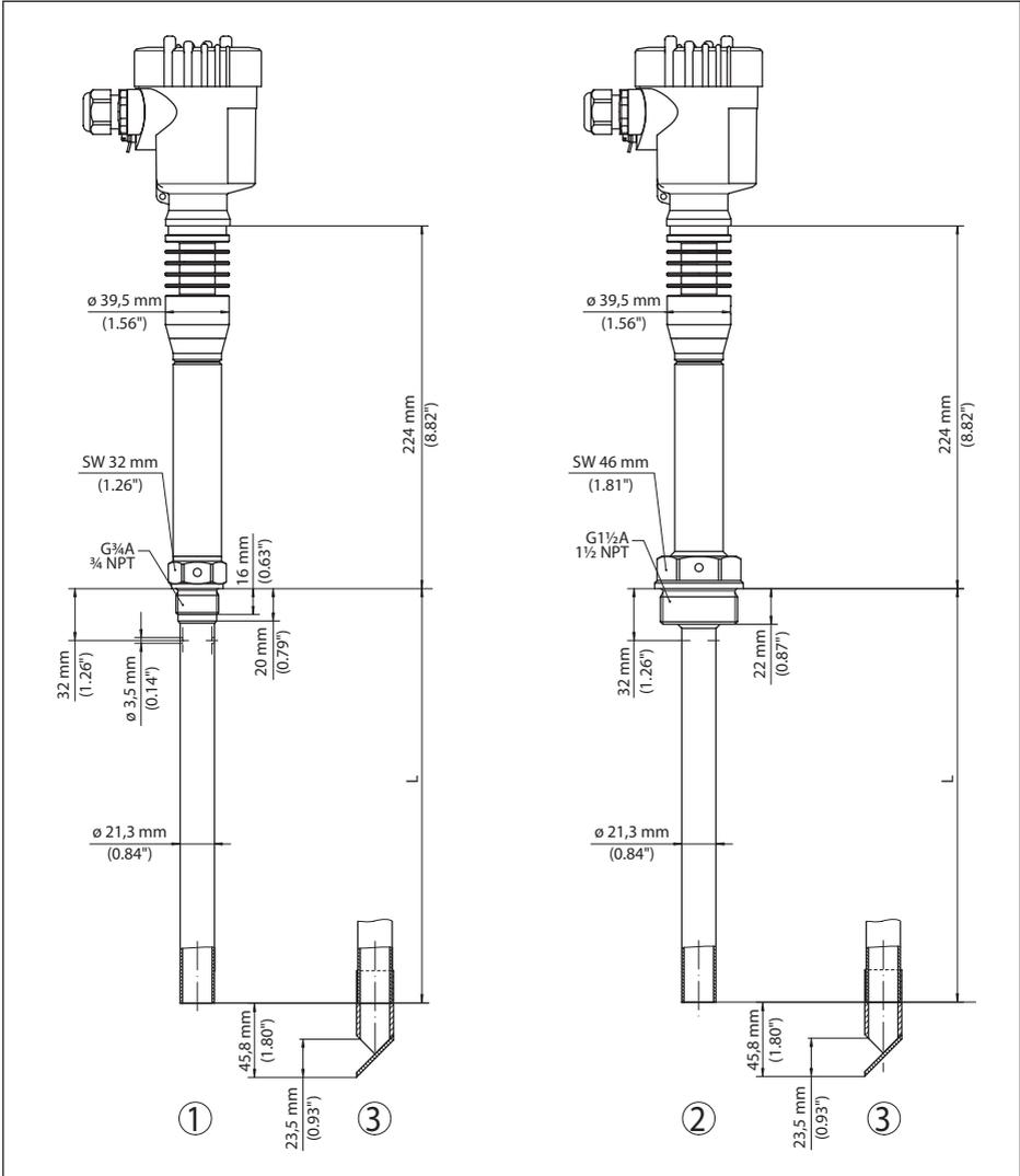
Abb. 37: VEGAPULS 62, Standrohrausführung mit Gewinde<sup>9)</sup>
