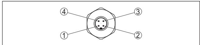
Abb. 12: Sicht auf den Steckverbinder M12 x 1
