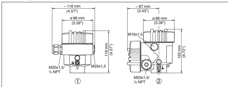
Abb. 33: Gehäuseausführungen in Schutzart IP 66/IP 68 (0,2 bar), (mit eingebautem Anzeige- und Bedienmodul vergrößert sich die Gehäusehöhe um 18 mm/0.71 in)
