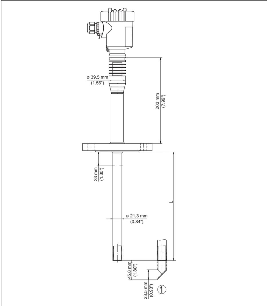
Abb. 38: VEGAPULS 62, Standrohrausführung mit Flansch<sup>10)</sup>
