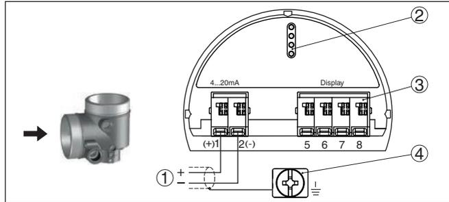
Abb. 6: Anschlussraum - Zweikammergehäuse
