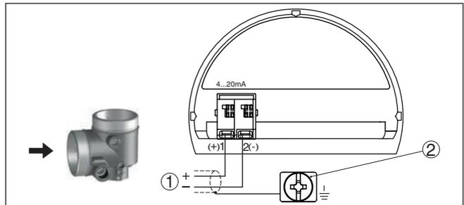
Abb. 9: Anschlussraum - Ex-d-ia-Zweikammergehäuse
