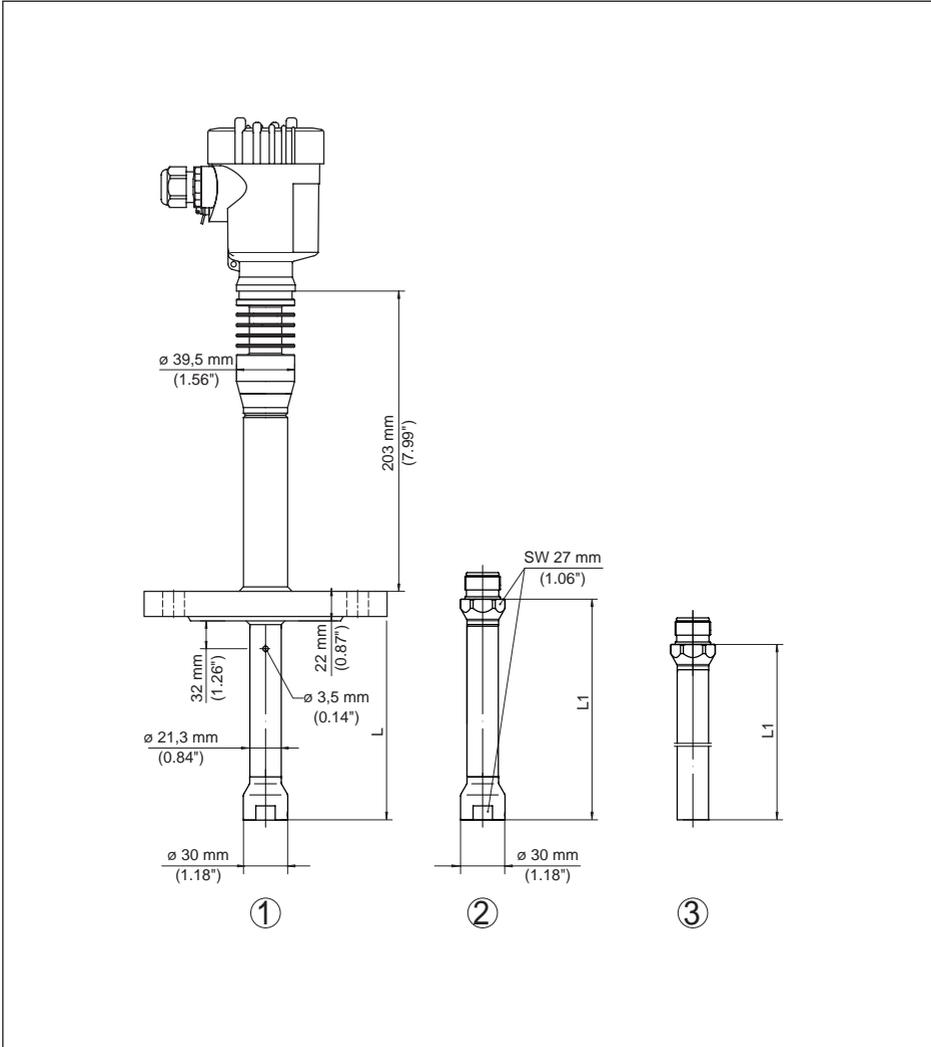
Abb. 40: VEGAPULS 62, Ausführung für Standrohrverlängerung mit Flansch<sup>12)</sup>
