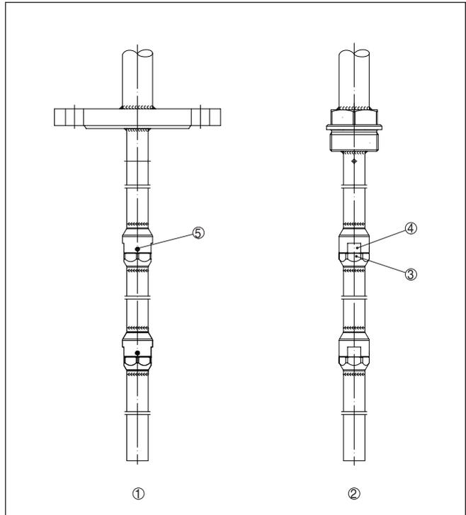
Abb. 2: Zusammengebaute mehrteilige Standrohrantenne
