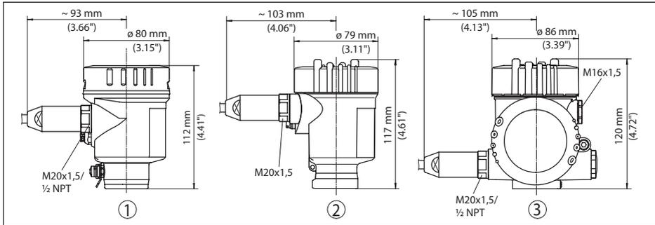
Abb. 36: Gehäuseausführungen in Schutzart IP 66/IP 68 (1 bar), (mit eingebautem Anzeige- und Bedienmodul vergrößert sich die Gehäusehöhe um 18 mm/0.71 in)
