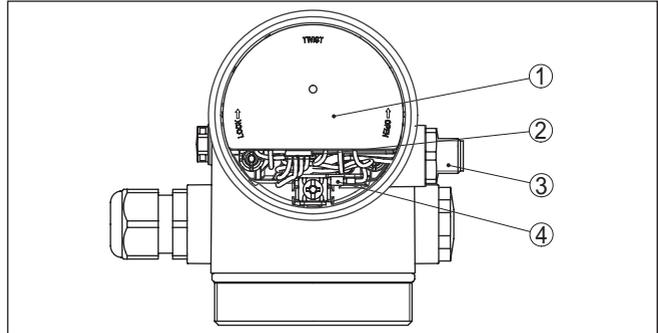
Abb. 11: Sicht auf den Elektronikraum mit VEGADIS-Adapter zum Anschluss der externen Anzeige- und Bedieneinheit
