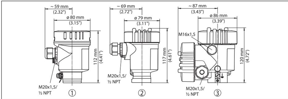
Abb. 42: Gehäuseausführungen in Schutzart IP66/IP68 (0,2 bar), (mit eingebautem Anzeige- und Bedienmodul vergrößert sich die Gehäusehöhe um 18 mm/0.71 in)
