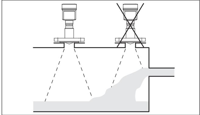
Abb. 6: Montage des Radarsensors bei einströmendem Medium
