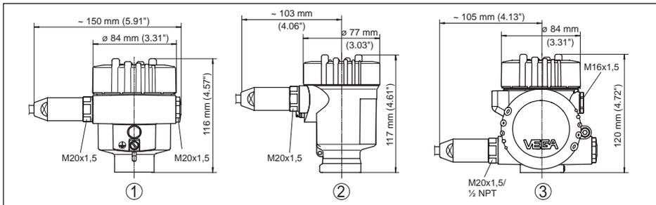
Abb. 43: Gehäuseausführungen in Schutzart IP66/IP68 (1 bar), (mit eingebautem Anzeige- und Bedienmodul vergrößert sich die Gehäusehöhe um 18 mm/0.71 in)
