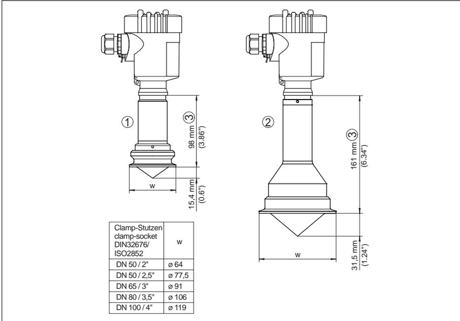
Abb. 47: VEGAPULS 63, Hygieneanschluss 2
