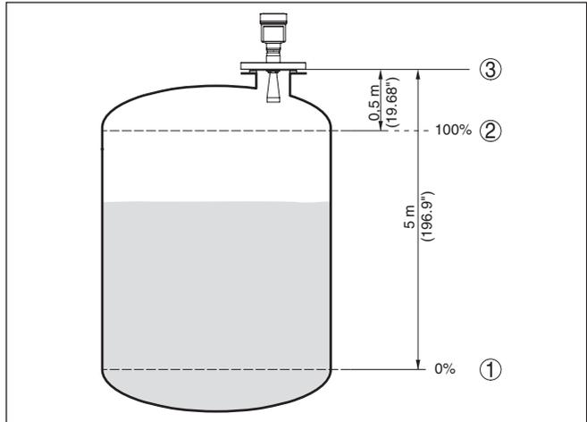
Abb. 32: Parametrierbeispiel Min./Max.-Abgleich
