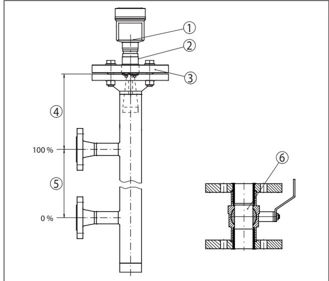
Abb. 16: Aufbau Bypass
