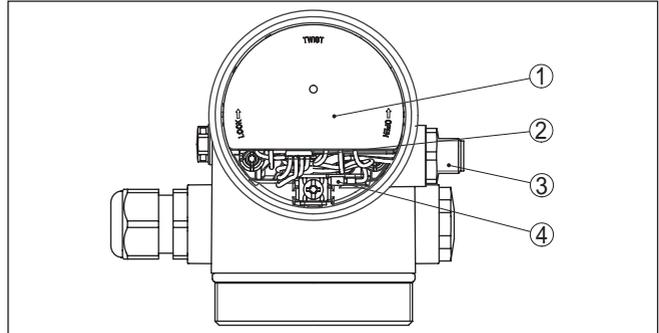
Abb. 25: Sicht auf den Elektronikraum mit VEGADIS-Adapter zum Anschluss der externen Anzeige- und Bedieneinheit
