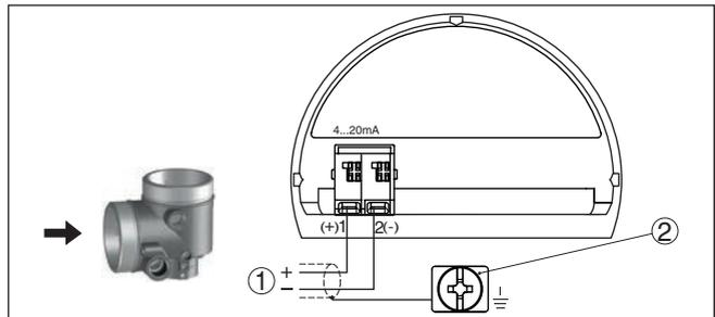
Abb. 23: Anschlussraum - Ex-d-ia-Zweikammergehäuse
