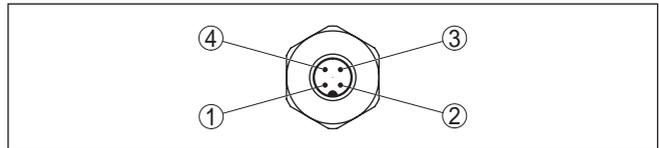
Abb. 26: Sicht auf den Steckverbinder M12 x 1
