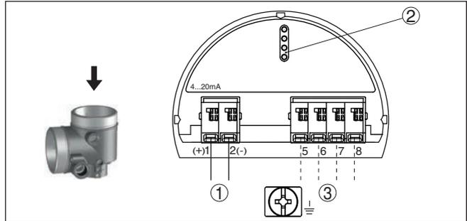
Abb. 22: Elektronikraum - Ex-d-ia-Zweikammergehäuse
