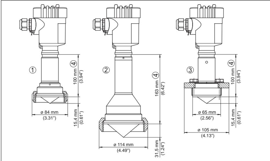
Abb. 49: VEGAPULS 63, Hygieneanschluss 4
