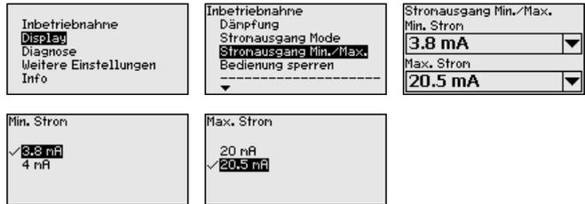
Die Werkseinstellung ist Min.-Strom 3,8 mA und Max.-Strom 20,5 mA.
