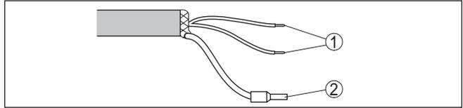
Abb. 27: Aderbelegung fest angeschlossenes Anschlusskabel
