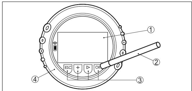
Abb. 31: Anzeige- und Bedienelemente - mit Bedienung über Magnetstift
