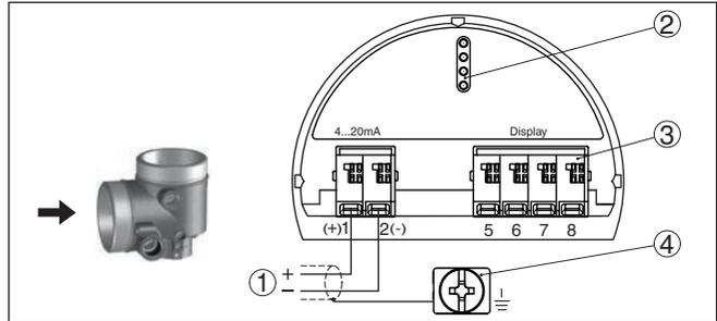
Abb. 20: Anschlussraum - Zweikammergehäuse
