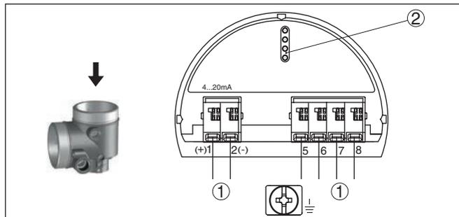
Abb. 19: Elektronikraum - Zweikammergehäuse
