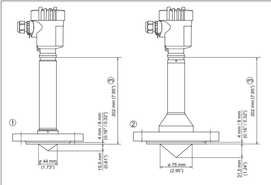
Abb. 45: VEGAPULS 63, Flanschausführung, Tieftemperatur
