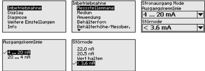
Die Werkseinstellung ist Ausgangskennlinie 4 ... 20 mA, der Störmode < 3,6 mA.
