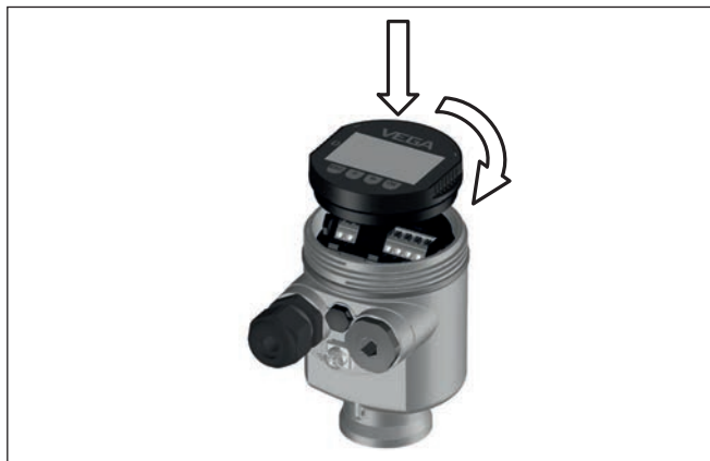
插图. 28: 将显示和调整模块装入单腔式壳体的电子部件腔中
