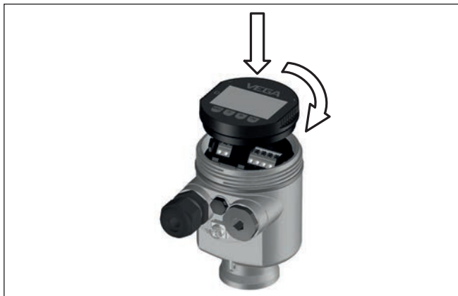
Abb. 23: Einsetzen des Anzeige- und Bedienmoduls beim Einkammergehäuse im Elektronikraum
