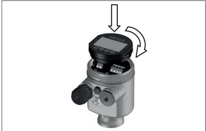
Abb. 28: Einsetzen des Anzeige- und Bedienmoduls beim Einkammergehäuse im Elektronikraum
