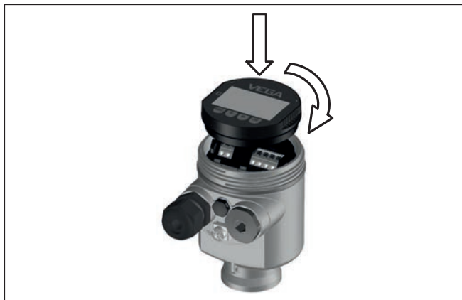
Figura 26: Inserimento del tastierino di taratura con display nel vano dell'elettronica in caso di custodia ad una camera
